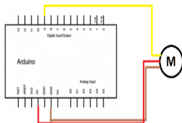
Рис. 14. Схема подключения серводвигателя SG90
