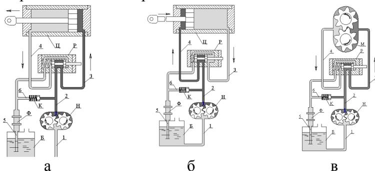
Рис. 2: а - принципиальные схемы нерегулируемого гидропривода возвратно-поступательного движения;
