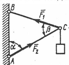
Шарнирный трехзвенник  $ABC$  удерживает в равновесии груз, подвешенный к шарнирному болту  $C$ . Под действием груза стержень  $AC$  сжат силой  $F_2 = 25$  Н. Заданы углы  $\alpha = 60^\circ$  и  $\beta = 45^\circ$ . Считая стержни  $AC$  и  $BC$  невесомыми, определить усилие в стержне  $BC$ .
