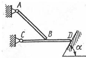
Однородная балка  $AB$ , вес которой  $200\text{ Н}$ , свободно опирается в точке  $B$  на горизонтальную балку  $CD$ . Определить, с какой силой балка  $CD$  действует на опорную плоскость в точке  $D$ , если расстояние  $CB = BD$ , угол  $\alpha = 60^\circ$ . Весом балки  $CD$  пренебречь.
