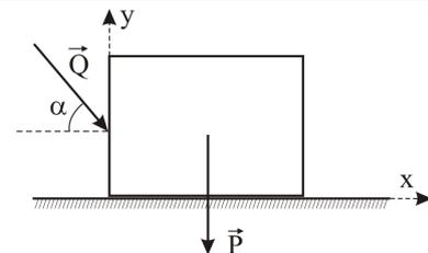
Дано:  $P = 10 \text{ кН}$ ;  $\alpha = 30^\circ$ ; коэффициент трения  $f = 0.4$ .
