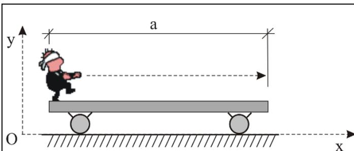
Человек, масса которого  $m_2 = 60$  кг, переходит с одного края платформы на другой. Масса платформы  $m_1 = 240$  кг; длина  $a = 5$  м. В начальный момент времени система покоилась. Сопротивление движению платформы не учитывается. Чему равна проекция перемещения платформы на ось  $Ox$ .
