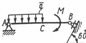
Определить момент  $M$  пары сил, при котором реакция опоры  $B$  равна 250 Н, если интенсивность распределенной нагрузки  $q = 150$  Н/м, размеры  $AC = CB = 2$  м.
