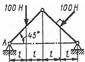
Определить вертикальную составляющую реакции в шарнире  $A$ .
