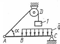
Балка  $AC$  закреплена в шарнире  $C$  и поддерживается в горизонтальном положении веревкой  $AD$ , перекинутой через блок. Определить интенсивность распределенной нагрузки  $q$ , если длины  $BC = 5$  м,  $AC = 8$  м, угол  $\alpha = 45^\circ$ , а вес груза  $l$  равен 20 Н.
