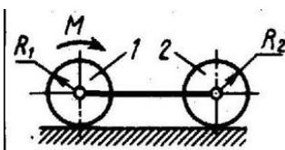
Однородные цилиндрические катки  $1$  и  $2$  массой  $20$  кг каждый приводятся в движение из состояния покоя постоянным вращающим моментом пары сил  $M = 2$  Н·м. Определить скорость осей катков при их перемещении на расстояние  $3$  м, если радиусы  $r_2 = r_1 = 0,2$  м.
