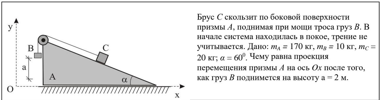
Брус  $C$  скользит по боковой поверхности призмы  $A$ , поднимая при помощи троса груз  $B$ . В начале система находилась в покое, трение не учитывается. Дано:  $m_A = 170$  кг,  $m_B = 10$  кг,  $m_C = 20$  кг;  $\alpha = 60^\circ$ . Чему равна проекция перемещения призмы  $A$  на ось  $Ox$  после того, как груз  $B$  поднимется на высоту  $a = 2$  м.
