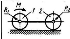
Однородные цилиндрические катки  $1$  и  $2$  массой  $20$  кг каждый приводятся в движение из состояния покоя постоянным вращающим моментом пары сил  $M = 2$  Н·м. Определить скорость осей катков при их перемещении на расстояние  $3$  м, если радиусы  $r_2 = r_1 = 0,2$  м.
