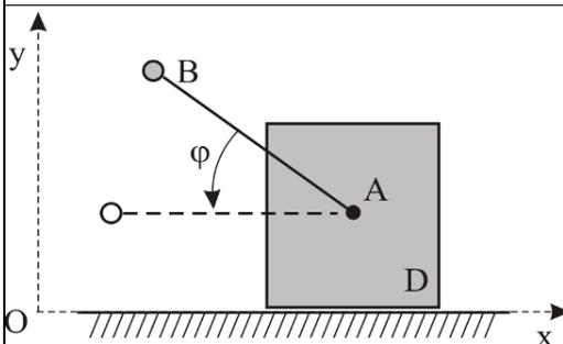
Стержень  $l = 1$  м, несущий на конце шарик  $B$  массой  $m_B = 10$  кг может вращаться вокруг оси  $A$ . Брус  $D$  массой  $m_D = 90$  кг находится на гладкой горизонтальной плоскости. Массой стержня пренебречь. В начальный момент система покоилась. Чему равна проекция перемещения бруса на ось  $Ox$ , если стержень из начального положения  $\varphi = 60^\circ$  перейдет в горизонтальное.
