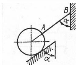
Однородный шар весом 12 Н удерживается в равновесии на гладкой наклонной плоскости с помощью веревки  $AB$ . Определить давление шара на плоскость, если угол  $\alpha = 60^\circ$ .
