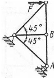
Определить усилие в стержне  $AB$ . Сила  $F = 400\text{ Н}$ .
