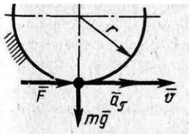
Материальная точка массой  $m = 0,1$  кг скользит по негладкой, вертикально расположенной направляющей радиуса  $r = 0,4$  м. В самом нижнем положении скорость точки  $v = 4$  м/с, а касательное ускорение  $a_\tau = 7$  м/с<sup>2</sup>. Определить мгновенное значение силы  $F$ , если коэффициент трения  $f = 0,1$ .
