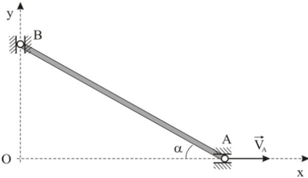
Ползун  $A$  в данный момент времени имеет скорость  $V_A = 4$  м/с;  $\alpha = 60^\circ$ . Определить скорость ползуна  $B$ .
