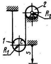
массой  $m_1 = m_2$  и радиусами  $r_1 = r_2$ , однородные диски, начинают движение из действия силы тяжести. Определить скорость того, как он опустился вниз на расстояние  $s = 3$  м.
