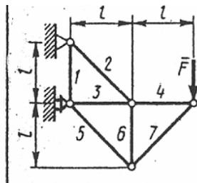
Определить усилие в стержне 3. Сила  $F = 460\text{ Н}$ .
