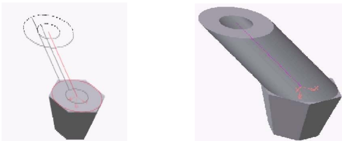
Рис. 5.27. - Фантом элемента модели при приклеивании кинематически
