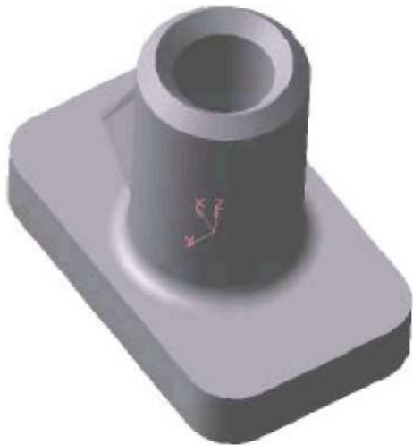
Рис. 7.3 - Модель с выполненными скруглениями
