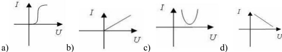
14. Если при токе  $I=5,25\text{A}$  напряжение на нелинейном элементе  $U=105\text{B}$ , а при возрастании тока на  $\Delta I=0,5\text{A}$ , напряжение будет равно  $115\text{B}$ , то дифференциальное сопротивление элемента составит...
