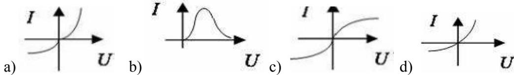
12. Для стабилизации тока используется нелинейный элемент с вольт-амперной характеристикой, соответствующей рисунку...
