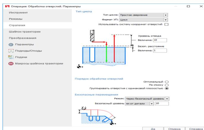
Рис. 36. Окно параметров операции сверления отверстий
