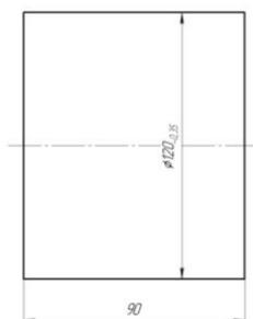
Рис. 8. Заготовка детали
