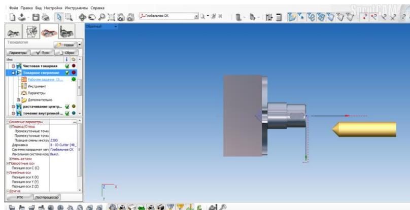
Рис. 42. Визуализация сверления центрального отверстия
