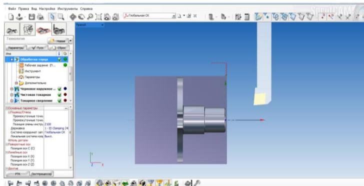
Рис. 13. Компьютерное моделирование механической обработки операции «обработка торца»
