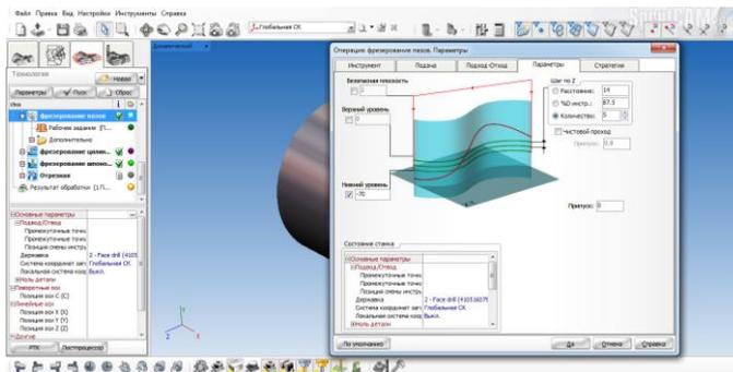
Рис. 27. Параметры фрезерования
