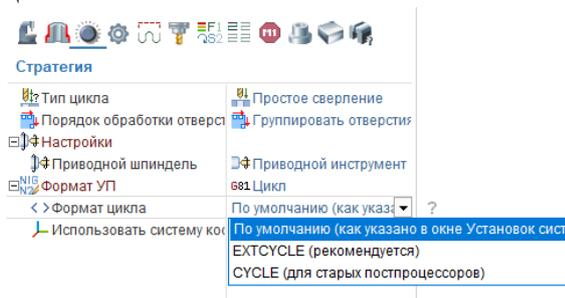
Рис.38. Формат цикла обработки отверстия
