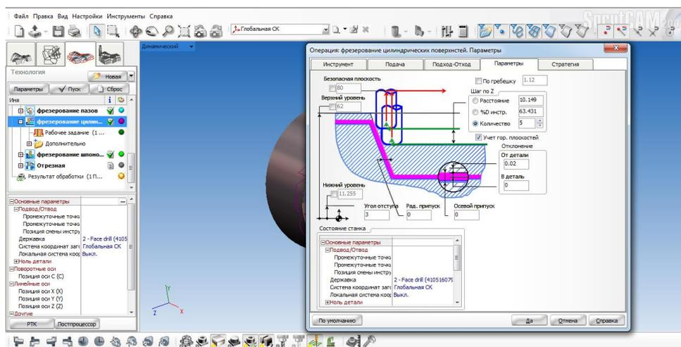
Рис. 46. Параметры безопасной плоскости
