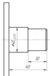
Рис. 19. Технологический чертеж чистового точения
