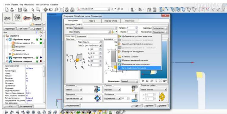
Рис. 9. Окно выбора типа режущего инструмента
