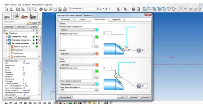
Рис. 21. Параметры зоны подхода-отхода инструмента
