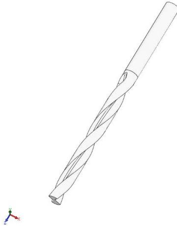
Рис. 8.10. 3D-модель основания сверла
