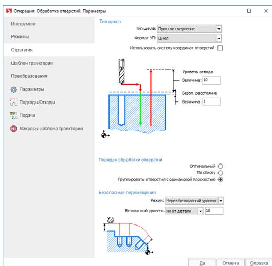
Рис. 3. Окно параметров операции сверления отверстий
