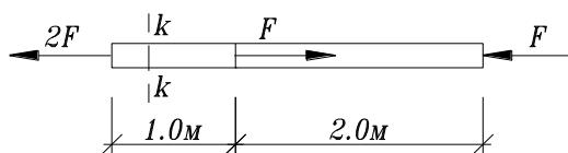
6. Определить напряжения в сечении k-k стержня, если  $A = 4 \text{ cm}^2$ ,  $F = 10 \text{ kN}$
