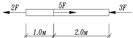
4. Определить вертикальную составляющую опорной реакции в заделке А.
