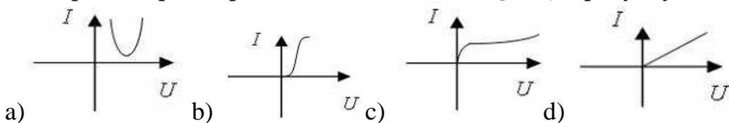
**13. Для стабилизации напряжения используется элемент с вольт-амперной характеристикой, соответствующей рисунку...**
