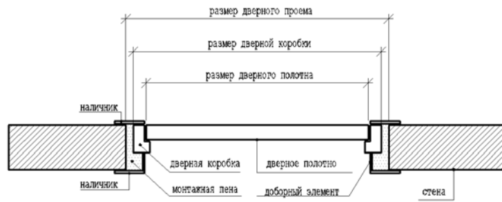
Рис. 10.7. Дверной проем и дверная коробка схема в плане
