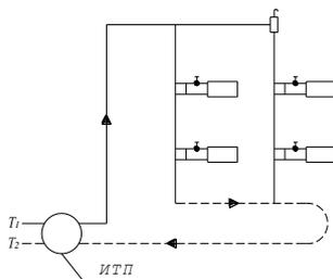
а) Система водяного отопления с верхней разводкой подающей магистрали, осевыми замыкающими участками;
