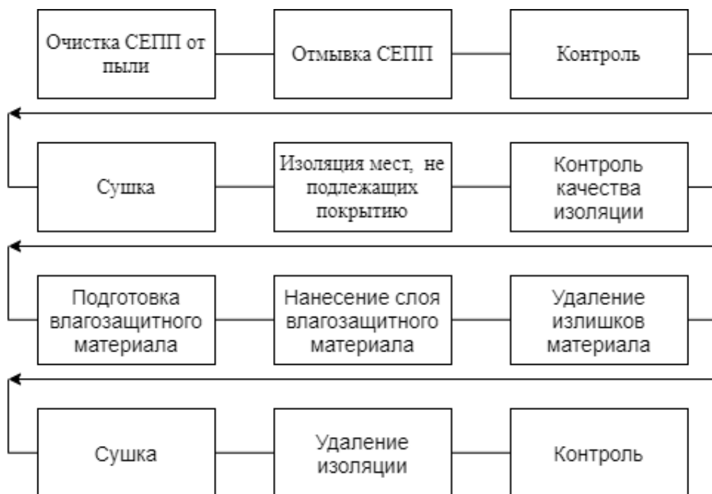
Рис. 1 - Структурная схема ТП влагозащиты СЕПП
