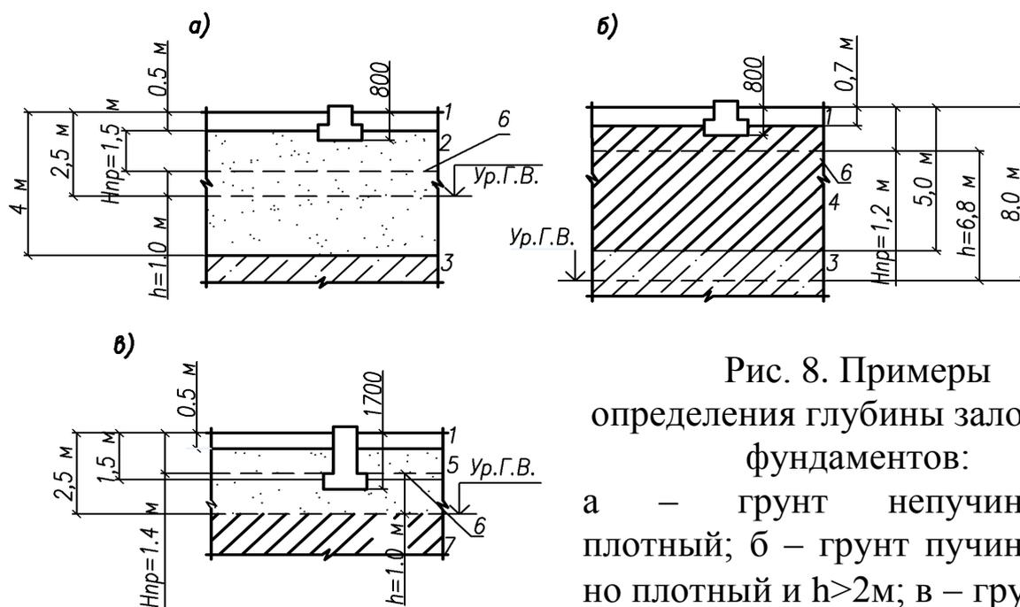
Рис. 8. Примеры определения глубины заложения фундаментов:
