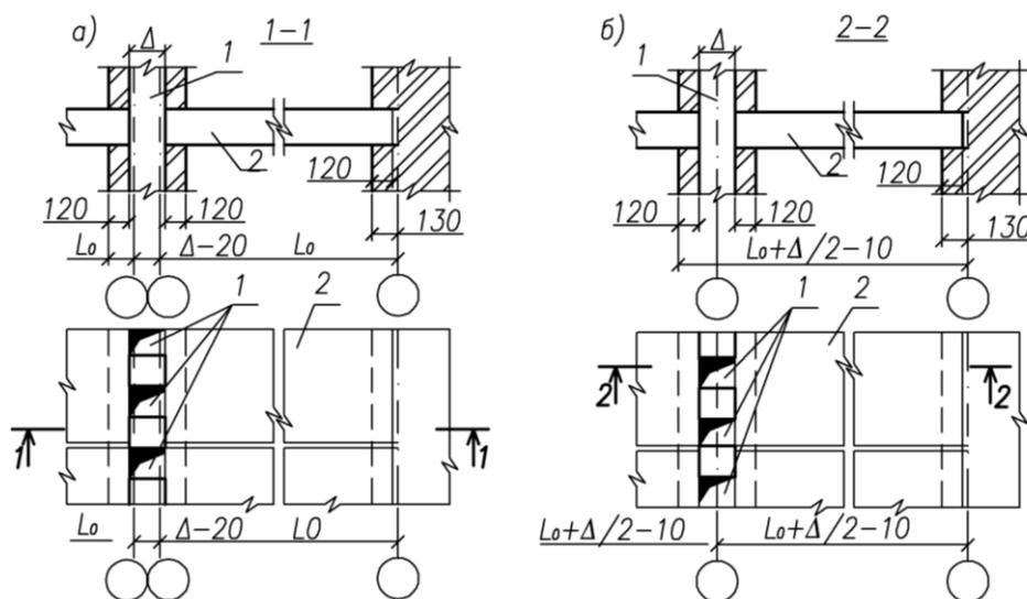
Рис. 2. Примеры привязки к разбивочным осям внутренних стен с вентиляционными каналами: а – применение парных осей; б – осевая привязка с увеличением величины пролета на  $\Delta/2-10$ ;  $\Delta$  - ширина вентиляционного канала:
