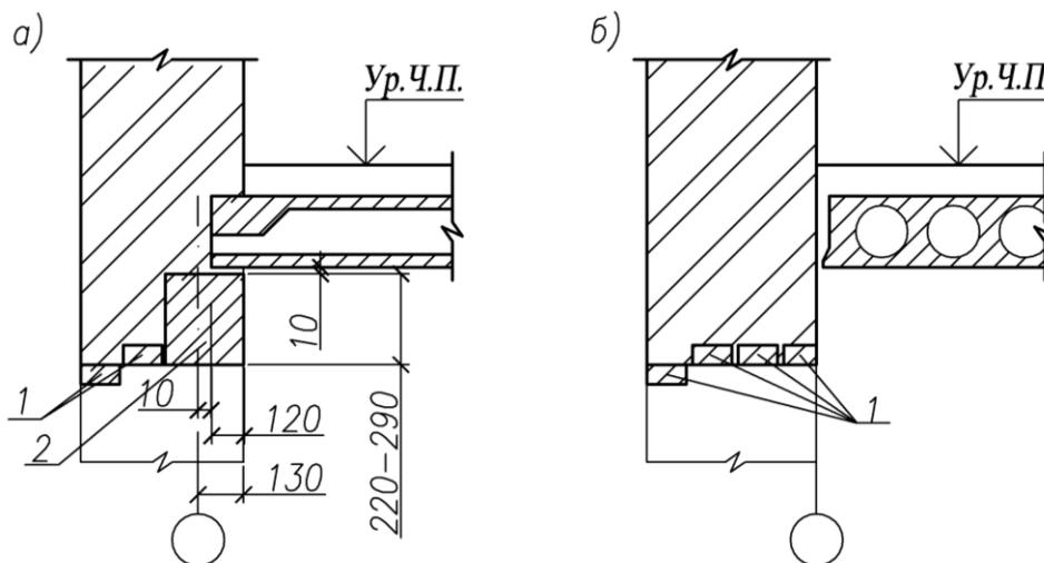
Рис. 1. Схемы укладки перемычек над проёмом:
