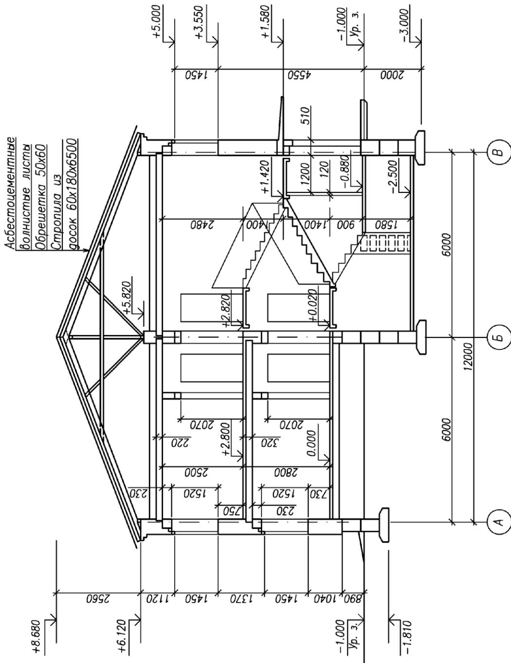
Рис. 15. Поперечный разрез двухэтажного кирпичного дома
