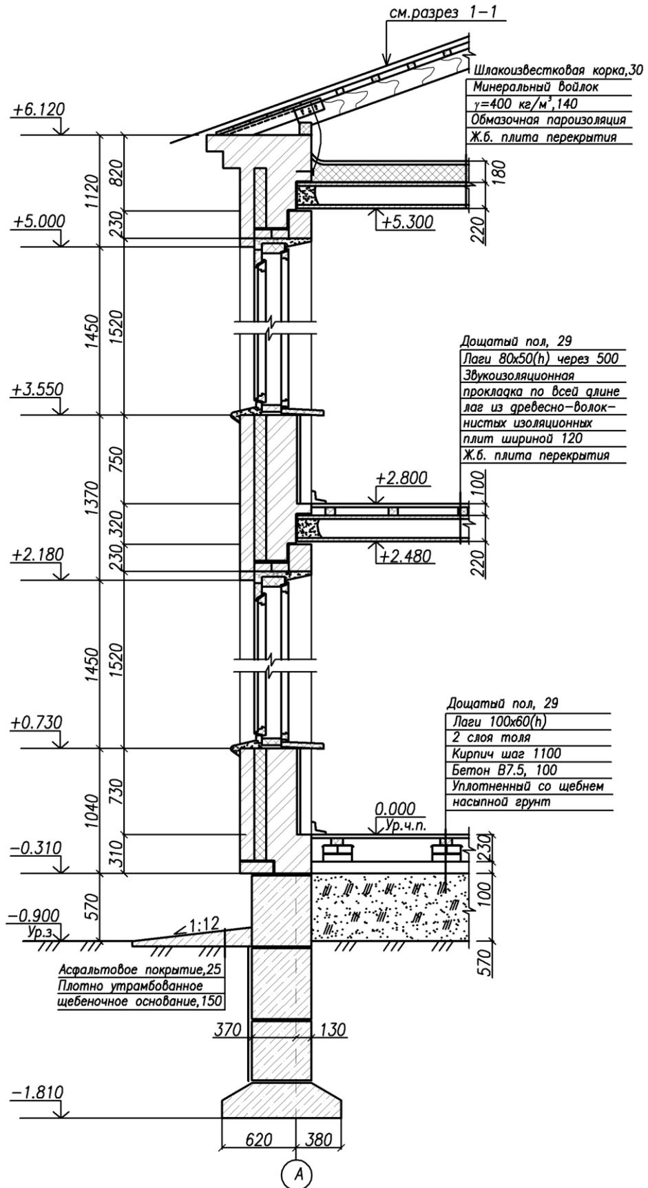
Рис. 16. Конструктивный разрез по кирпичной стене
