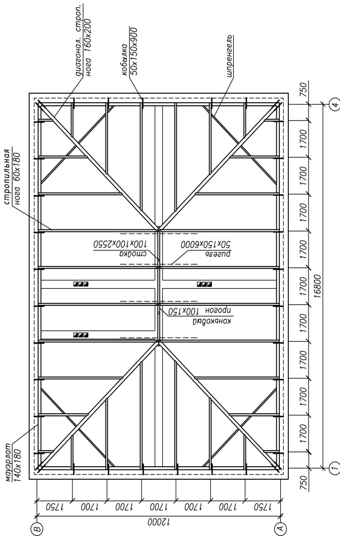
Рис. 14. Схема расположения наслонных стропил
