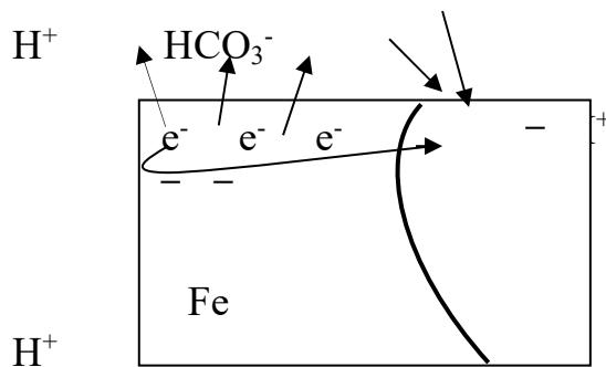
Схема электрохимической коррозии железа в кислой среде
