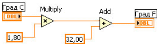
Рис.4. Блок-диаграмма ВП «Преобразование температуры»
