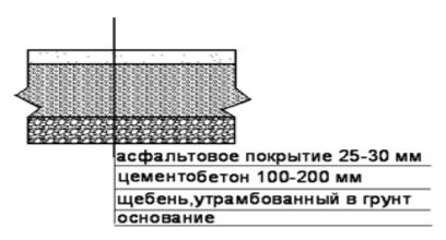
Рис. 14.4. Схема пола с асфальтовым покрытием
