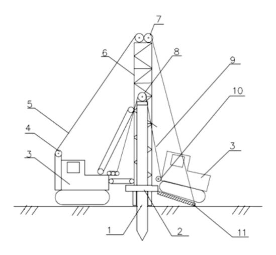
Рис. 6.14. Схема погружения сваи вдавливанием: 1 — свая; 2 — рама; 3 — трактор; 4 — лебедка; 5 — растяжки штанги; 6 — штанга; 7 — блоки; 8 — оголовник; 9 — вдавливающий канат; 10 — вдавливающая лебедка; 11 — опорная плита
