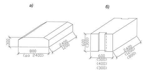
**Рис. 5.2.** Элементы сборных ленточных фундаментов: а) – фундаментная плита; б) – стеновой фундаментный блок
