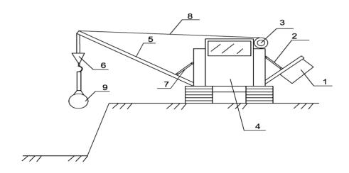
Рис. 15.3. Схема крана-трубоукладчика:
