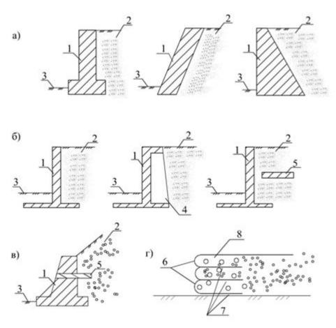
Рис. 4.24. Конструкции подпорных стен:
