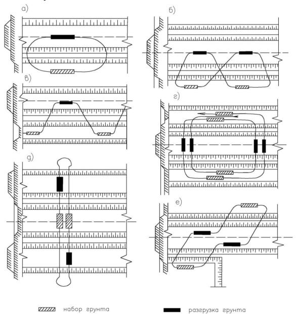
Рис. 4.7. Схемы движения скреперов:
