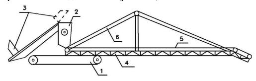
Рис. 8.15. Бетоноукладчик на самоходном шасси:
