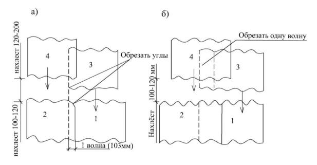
Рис. 11.5. Способы покрытия кровли асбестоцементными волнистыми листами: а) – без смещения кромок; б) – со смещением кромок; 1-4 – последовательность укладки листов
