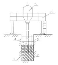
Рис. 5.7. Схема укладки бетона методом ВПТ:
