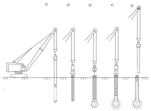
Рис. 6.21. Технологическая схема устройства вибротрамбованных свай:
