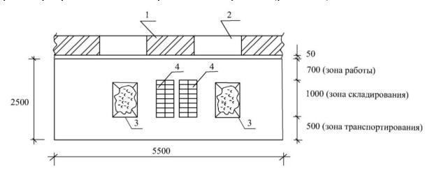
**Рис. 7.12.** Организация рабочего места каменщиков: 1 – простенок; 2 – проем; 3 – ящики с раствором; 4 –поддоны с кирпичом
