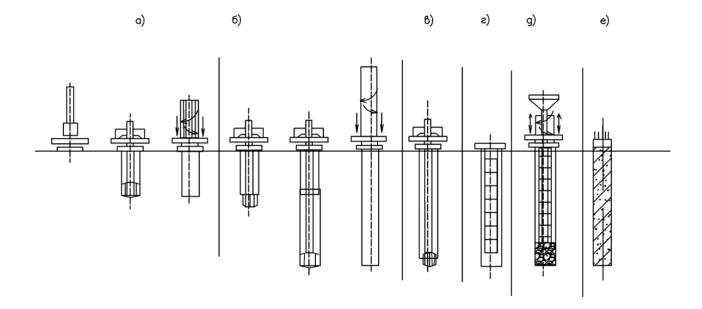
**Рис. 6.19.** Технологическая схема устройства буронабивных свай с применением обсадных труб:
