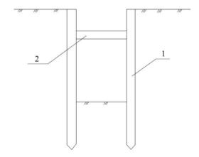
**Рис. 4.20.** Схема шпунтового ограждения стенок траншей: 1 — шпунтовое ограждение; 2 — распорки
