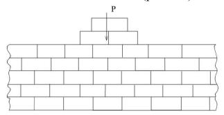
Рис. 7.2. Правильное расположение рядов камней под действием вертикальной нагрузки
