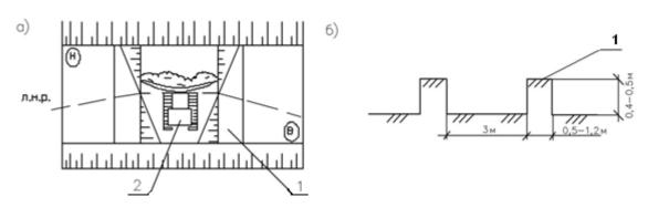
**Рис. 4.4.** Траншейный способ разработки грунтов бульдозером: а) – план строительной площадки; б) – разрез; 1 – валы; 2 – бульдозер
