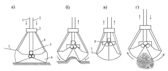
Рис. 4.14. Схема работы двухчелюстного грейфера:
