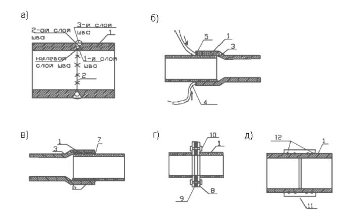
Рис. 15.1. Схемы соединения труб:
