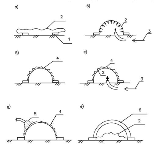
Рис. 8.7. Схема бетонирования оболочки на пневмоопалубке:
