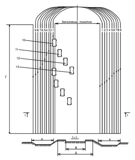
**Рис. 4.9.** Схема возведения насыпи из боковых резервов: A — ширина резерва; B — ширина насыпи; B — ширина корыта, покрываемого одеждой;  $\Gamma$  — рабочая длина захватки; 1-9 — валики грунта, вырезаемые из резерва; 10-13 — автогрейдеры
