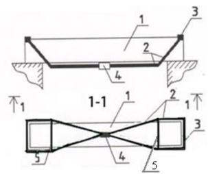
Рис. 16.15. Схема усиления железобетонной балки шпренгельной затяжкой: 1 — усиливаемая конструкция; 2 — преднапряжённый шпренгель из арматурной или прокатной стали; 3 — опорное устройство; 4 — стяжной хомут; 5 — распорки
