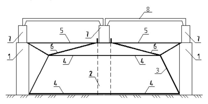
**Рис. 16.21.** Схема разрежения шага колонн путем замены четных колонн полигональными трехшарнирными арками:
