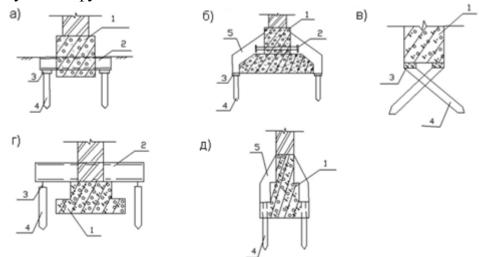
Рис. 16.1. Способы соединения свай с существующими фундаментами: а), б), в) — для ленточных фундаментов; г) и д) — для одиночных фундаментов; 1 — существующий фундамент; 2 — металлическая или железобетонная рандбалка; 3 — свайный ростверк; 4 — набивная свая; 5 — дополнительное бетонирование фундамента
