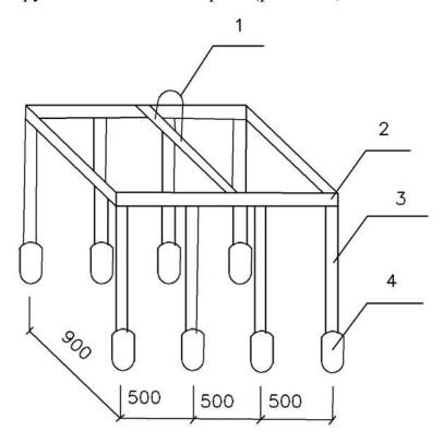
**Рис. 8.20.** Пакет глубинных вибраторов: 1 – серьга; 2 – рама; 3 – штанга; 4 – вибробулава
