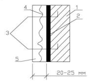
Рис. 10.2. Штукатурная гидроизоляция: 1 — изолируемая конструкция; 2 — грунтовочный слой; 3 — анкера; 4 — металлическая сетка; 5 — штукатурная изоляция
