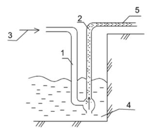
Рис. 3.5. Схема водопонижения с помощью эрлифта: 1 – газовая труба; 2 – жидкостная труба; 3 – подача воздуха; 4 – вода в котловане; 5 – отведение эмульсии
