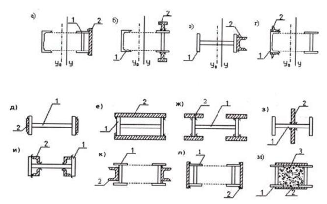
**Рис. 16.9.** Схемы усиления колонн путем увеличения сечений: а)-г) – при внецентренном сжатии; д)-м) – при центральном сжатии; 1 – усиливаемая колонна; 2 – элементы усиления; 3 – бетон или железобетон
