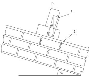
**Рис. 7.3.** Растрескивание кладки при несоблюдении первого правила разрезки: 1 – сдвигающее усилие; 2 – трещины в кладке
