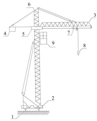
Рис. 9.8. Башенный кран с неповоротной башней:
