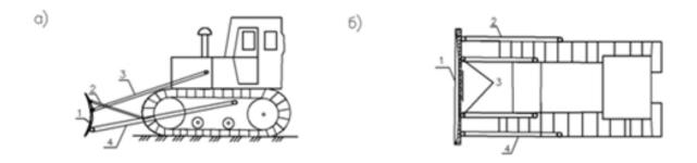
Рис. 4.2. Бульдозер с неповоротным отвалом: а) – вид сбоку; б) – вид сверху; 1 – отвал; 2 – раскосы; 3 – гидроцилиндры подъема отвала; 4 – толкающие брусья
