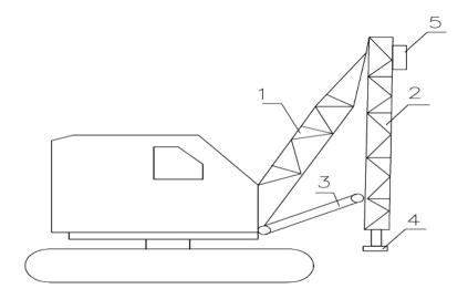
**Рис. 6.11**. Навесное копровое оборудование на экскаваторе (КО): 1 — экскаваторная стрела; 2 — копровая стрела; 3 — гидроцилиндры; 4 — домкрат или телескопическая пята; 5 — свайный молот
