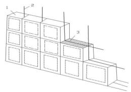
**Рис. 13.17.** Схема остекления из стеклоблоков: 1 – блоки; 2 – арматурный стержень; 3 – раствор или клей
