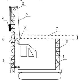
Рис. 6.10. Копер на тракторной основе (КН):
