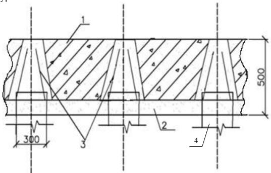
Рис. 6.24. Схема сопряжения балок сборного ростверка со сваями:
