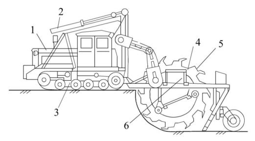
Рис. 4.16. Роторный экскаватор продольного копания: 1 — двигатель; 2 — гидроцилиндры подъёма ротора; 3 — гусеничное шасси; 4 — ротор; 5 — ковши; 6 — ленточный транспортер
