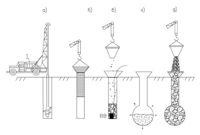
Рис. 6.23. Технологическая схема устройства свай с камуфлетной пятой:
