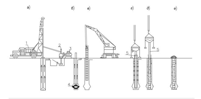
Рис. 6.18. Технологическая схема устройства буронабивных свай под глинистым раствором: а) – бурение скважины; б) – устройство уширенной полости; в) – установка арматурного каркаса; г) – установка бетонолитной трубы с вибробункером и воронкой; д) – бетонирование скважины методом ВПТ; е) – утепление оголовка сваи в зимних
