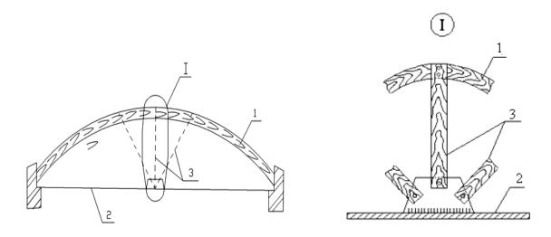
**Рис. 16.17.** Схема усиления деревянной арки введением решетки из деревянных элементов: 1 — усиливаемая арка; 2 — затяжка арки; 3 — элементы деревянной решётки, вводимые для усиления
