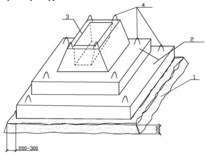
**Рис. 5.4.** Сборный монолитный фундамент стаканного типа: 1– песчаная подушка; 2 – фундаментные плиты; 3 – стакан фундамента; 4 – монтажные петли
