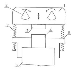
**Рис. 6.9.** Схема пружинного вибромолота: 1 – вибровозбудитель; 2 – дебалансы; 3 – ударник; 4 – наковальня; 5 – наголовник; 6 – свая; 7 – пружины
