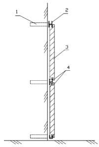
**Рис. 13.16**. Безрастворный способ облицовки стен с боковой задвижкой плит: 1 – пробки; 2 – алюминиевый профиль в виде двутавра; 3 – плита; 4 – паз
