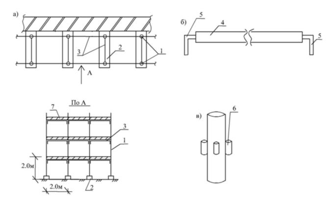
Рис. 7.10. Схема установки трубчатых безболтовых лесов:
