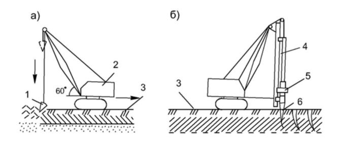
Рис. 4.43. Схема рыхления мерзлых грунтов (динамическое): а) — рыхление клиновым молотом (клин-бабой); б) — рыхление дизель-молотом; 1 — клин-баба; 2 — экскаватор; 3 — мерзлый слой грунта; 4 — направляющая штанга; 5 — дизель-молот; 6 — клин
