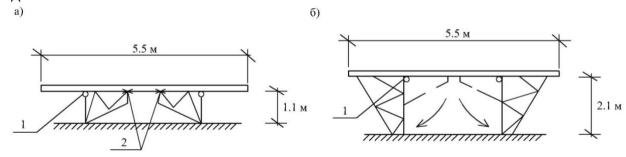
**Рис. 7.9.** Шарнирно-панельные подмости: а) — для кладки 2-го яруса; б) — для кладки 3-го яруса; 1 — шарнир; 2 — крепление
