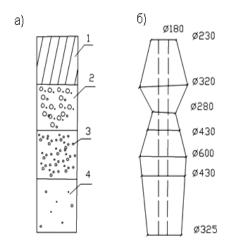
Рис. 16.4. Пример формирования сваи РИТ в слоях различных грунтов:
