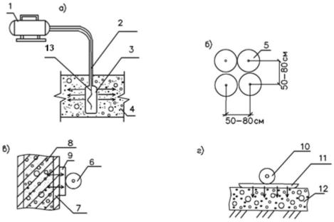
Рис. 8.19. Схемы работы вибраторов различных типов:
