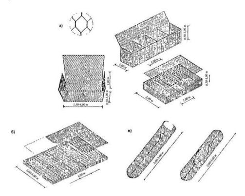
**Рис. 4.26.** Типы арматурно-сетчатых каркасов: а) — коробчатые; б) — матрасно-тюфячные; в) — цилиндрические
