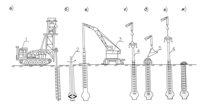
**Рис. 6.17.** Технологическая схема устройства буронабивных свай сухим способом: а) – бурение скважины; б) – устройство уширенной полости;
