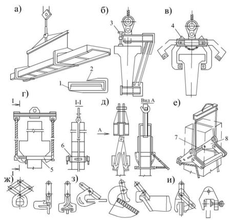
Рис. 9.14. Схемы подъёма конструкций механическими захватными устройствами:
