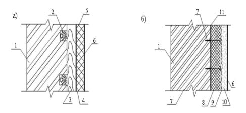
Рис. 16.24. Схема утепления стен теплоизоляционной штукатуркой:
