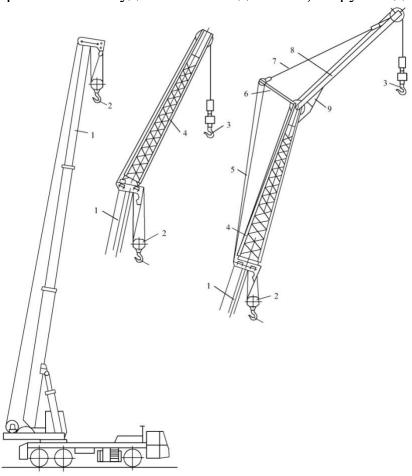
Рис. 9.5. Сменное оборудование крана на специальном автомобильном шасси КС-5473: 1 — основная стрела; 2 — крюк основного подъёма; 3 — крюк вспомогательного подъёма; 4 — удлинитель; 5 — оттяжка гуська; 6 — стойка; 7 — тяга гуська; 8 — неуправляемый гусек; 9 — подкос
