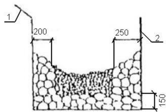
Рис. 4.27. Заполнение коробчатых каркасов камнем: 1 – крыша, 2 – лицевая сторона
