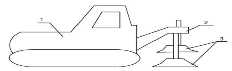
**Рис. 4.34.** Трамбующая машина принудительного трамбования: 1 — рабочий механизм; 2 — несущая рама; 3 — трамбующие плиты
