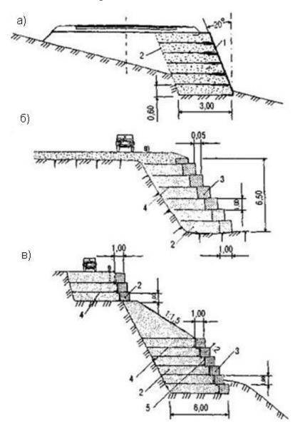
Рис. 4.25. Схемы укрепления откосов и берегов габионными конструкциями: а) – укрепление насыпи; б) – укрепление естественного откоса; в) – укрепление бермы и откоса берега реки или канала; 1 – матрасно-тюфячные габионы; 2 – уплотненный грунт; 3 – габионные ящики; 4 – каркас из металлических прутков; 5 – геотекстиль
