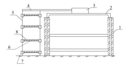
Рис. 7.11. Схема подвесных лесов:
