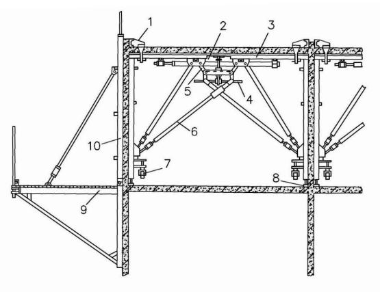
Рис. 8.3. Унифицированная объемно-переставная опалубка конструкции ЦНИИОМТП: 1 – опалубка маяков; 2 – центральная вставка; 3 – Г-образный щит; 4 – распалубочный винт; 5 – шарнирный распалубочный механизм; 6 – регулируемый подкос; 7 – катки; 8 – винтовой домкрат; 9 – подмости торцевых стен; 10 – щит торцевой стены
