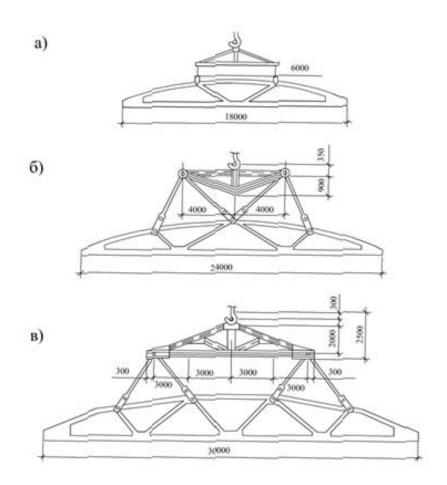
**Рис. 9.12.** Схемы строповки железобетонных ферм решётчатыми траверсами: а) – с двумя точками захвата; б) – с тремя точками захвата; в) – с четырьмя точками захвата
