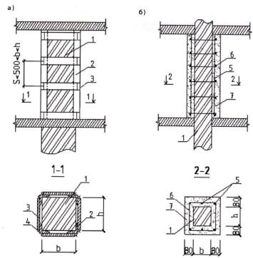
**Рис. 16.10.** Схемы усиления кирпичных колонн обоймами: а) — металлической; б) — из мелкозернистого бетона;
