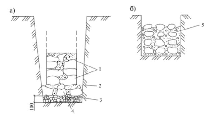
Рис. 7.13. Кладка из камней неправильной формы:
