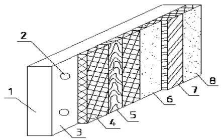
Рис. 16.23. Схема утепления стен плитным утеплителем: 1 – стена; 2 – деревянные пробки; 3 – клей; 4 – утеплитель; 5 – деревянные бруски; 6 – пароизоляция; 7 – облицовочные плиты; 8 – отделочный слой
