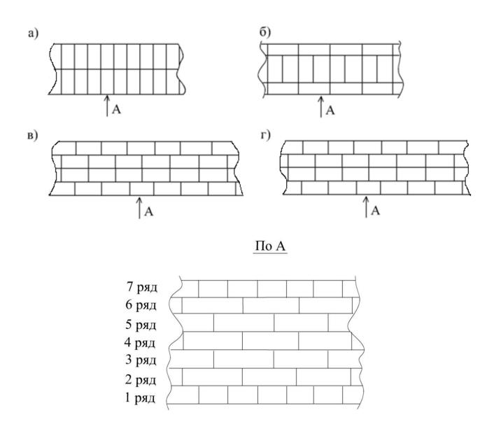
**Рис. 7.7.** Многорядная система перевязки швов при толщине стены в два кирпича: а) -1-й ряд; б) -2-й ряд; в) -3-й и 5-й ряды; г) -4-й и 6-й ряды
