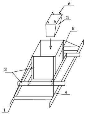
**Рис. 5.5.** Блок-форма для бетонирования монолитного фундамента под колонну: 1 – опалубка фундаментной плиты; 2 – опалубка стакана; 3 – опорные элементы; 4 – оттяжки; 5 – металлический вкладыш; 6 – монтажные петли
