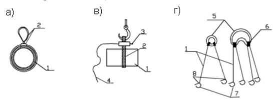
Рис. 15.4. Строповочные устройства для монтажа труб:
