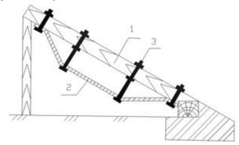
**Рис. 16.16.** Схема усиления стропильной ноги стропильной фермы шпренгельной фермой: 1 – усиливаемая конструкция; 2 – шпренгель из металла; 3 – натяжные болты
