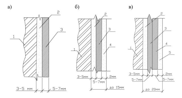
Рис. 13.1. Структура штукатурных покрытий:
