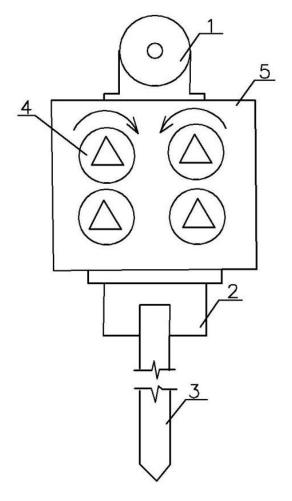
Рис. 6.8. Низкочастотный вибропогружатель: 1 – электродвигатель; 2 – наголовник; 3 – свая; 4 – дебалансные валы; 5 – корпус
