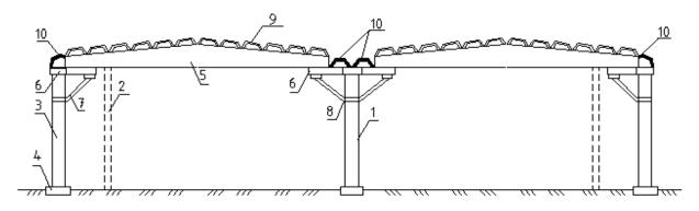
**Рис. 16.19.** Схема увеличения пролетов двухпролетного здания за счет раздвижки крайних колонн:
