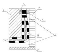
Рис. 10.3. Пример оклеечной гидроизоляции подземного угла сооружения: 1 — изолируемая конструкция; 2 — подстилающий слой из бетона; 3 — оклеечная гидроизоляция; 4 — выравнивающий слой из цементно-песчаного раствора; 5 — деревянная пробка; 6 — деревянная рейка; 7 — защитная стенка из кирпича; 8 — армированный слой цементно-песчаного раствора
