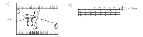
**Рис. 4.5.** Послойный способ разработки грунта бульдозером: а) – план строительной площадки; б) – разрез
