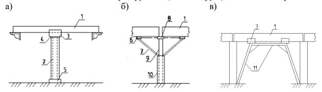
Рис. 16.13. Схема усиления железобетонных балок
