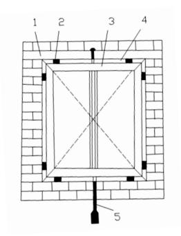
**Рис. 12.4.** Проверка правильности установки оконного блока в проем: 1 — железобетонная перемычка; 2 — клинья; 3 — оконный блок; 4 — зазор для герметизации; 5 — отвес
