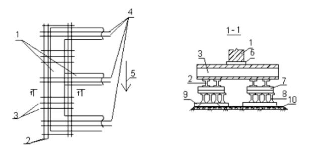
**Рис. 16.22.** Схема расположения ходовых, поперечных и рандбалок, подводимых под здание при его передвижке:
