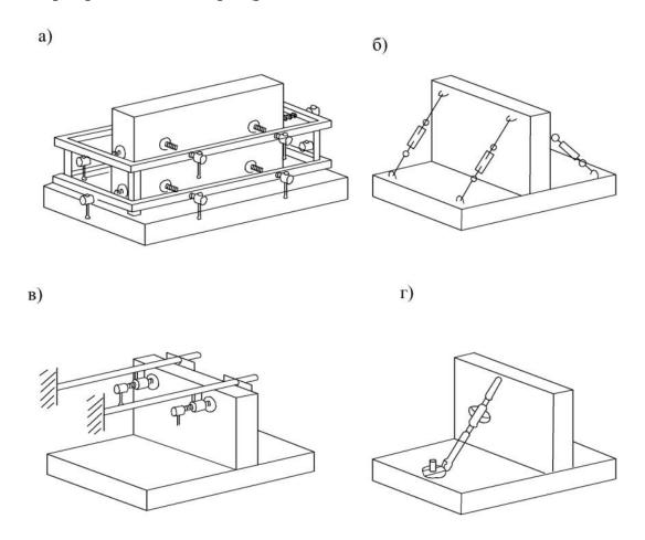
**Рис. 9.17**. Схемы применения индивидуальных крепёжных приспособлений при монтаже стеновых панелей крупнопанельного здания:
