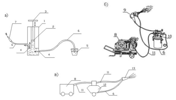
**Рис. 13.11.** Устройства для механизированного нанесения окрасочных составов и шпатлевок:
