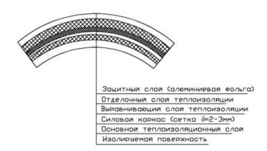
Рис. 10.5. Схема устройства обволакивающий теплоизоляции
