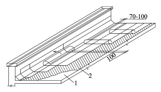
**Рис. 11.1.** Послойный способ наклейки рулонного ковра: 1- стяжка; 2- грунтовка
