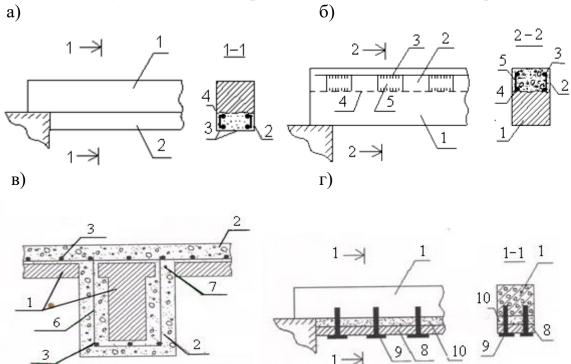
Рис. 16.14. Схема усиления железобетонных балок путем увеличения поперечного сечения:
