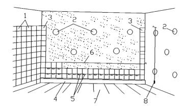
Рис. 13.14. Схема облицовки стен керамическими плитами: 1 – облицованная стена; 2 – марки; 3 – маячные плитки; 4 – рейка опорная; 5 – инвентарные скобы; 6 – шнур-причалка; 7 – плиты пола; 8 – отвес
