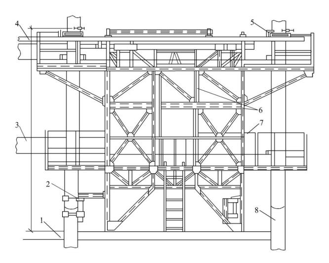
**Рис. 9.18.** Групповой кондуктор для монтажа каркасов многоэтажных домов: 1 — перекрытие; 2 — нижний угловой фиксатор; 3 — ригель; 4 — продольная тяга; 5 — верхний угловой фиксатор; 6 — конструкции кондуктора; 7 — выдвижные люльки; 8 — колонна
