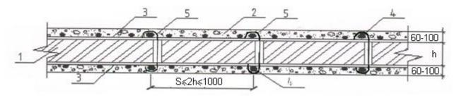
**Рис. 16.11.** Схема усиления кирпичной стены железобетонной набетонкой: 1 – усиливаемая стена; 2 – железобетонная набетонка; 3 – арматурные сетки; 4 –прижимные стержни поверх сеток; 5 – хомуты-связи, пропущенные через отверстия в стене
