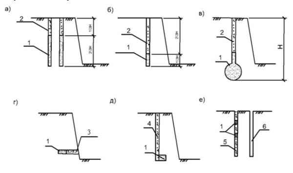
Рис. 4.44. Методы рыхления мерзлых грунтов взрывом:
