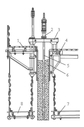
**Рис. 8.4.** Унифицированная скользящая опалубка конструкции ЦНИИОМТП: 1 – козырек; 2 – домкрат; 3 – домкратная рама; 4 – рабочий пол; 5 – домкратный стержень; 6 – щиты опалубки; 7, 8 – внутренние и наружные подвесные подмости
