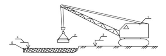
**Рис. 4.33.** Трамбующая машина со свободным падением трамбующей плиты: 1 – экскаватор; 2 – трамбующая плита; 3 – отметка поверхности грунта до трамбования; 4 – проектная отметка грунта; 5 – уплотненный грунт
