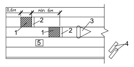
Рис. 11.3. Организация рабочего места звена кровельщиков: 1 – слой нанесенной мастики; 2 – наклеиваемый рулон; 3 – каток; 4 – подготовленные рулоны; 5 – бачок с мастикой
