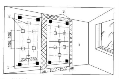
Рис. 13.12. Схема приклеивания гипсокартонных листов:
