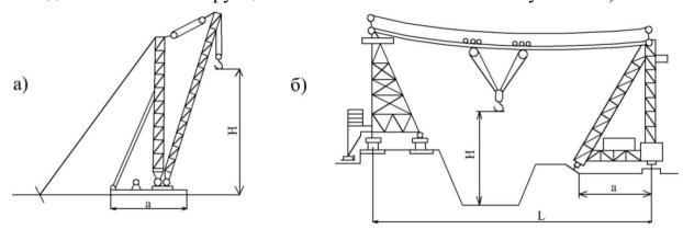
**Рис. 9.10.** Примеры специальных монтажный устройств: а) – жестконогий кран (деррик); б) – вантовый кран; а – база крана; H – высота подъёма крюка; L – пролёт крана
