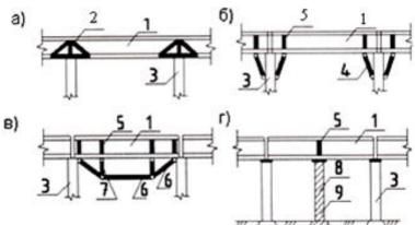
Рис. 16.7. Схемы усиления балок путем изменения конструктивной схемы:
