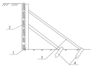
**Рис. 4.18.** Схема подкосного крепления стенок выемки: 1-стойки; 2-доски; 3-подкосы; 4-упорные свайки
