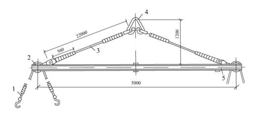
**Рис. 9.13.** Балочная траверса: 1- подвеска; 2- блок; 3- гибкие тяги; 4- скоба для подвески к грузовому крюку крана; 5- балка
