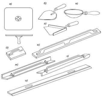
Рис. 13.4. Ручные инструменты для производства штукатурных работ:
