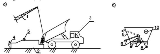
Рис. 8.14. Подача бетона способом «кран-бадья»:
