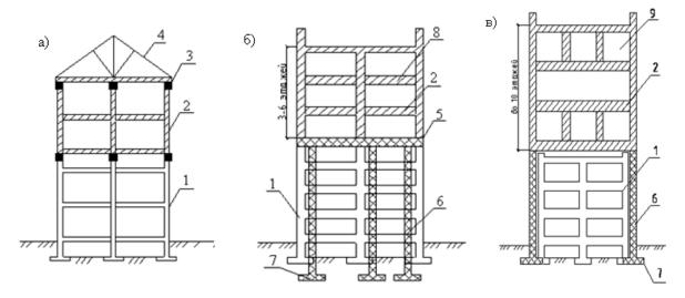
Рис. 16.18. Схемы надстройки зданий при реконструкции:
