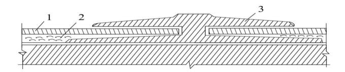
**Рис. 14.13.** Соединение пластмассового порожка с линолеумом в дверном проеме: 1 – линолеум; 2 – прослойка из клея; 3 – порожек
