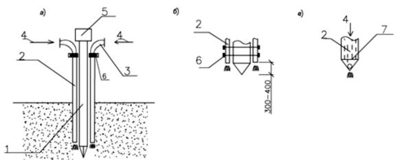
Рис. 6.16. Схема погружения свай гидроподмывом:
