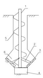
**Рис. 6.22.** Разбуривание полости в грунте уширителем: 1– буровая штанга; 2 – рычаги ножевого механизма; 3 – режущие ножи; 4 – ковшгрунтосборник; 5 – скважина; 6 – уширенная полость
