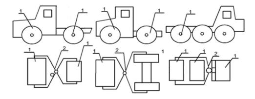
**Рис. 4.29.** Катки с гладкими вальцами – вид и кинематическая схема: 1 – гладкие вальцы; 2 – шарнирное сочленение рамы
