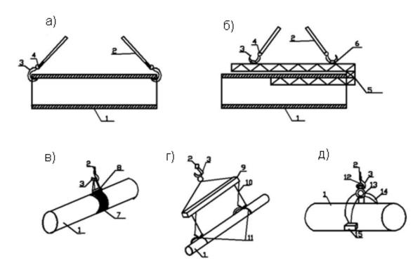
Рис. 15.5. Траверсы, захваты и другие устройства для подъема труб:
