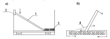
Рис. 14.7. Приспособление для сплачивания досок:
