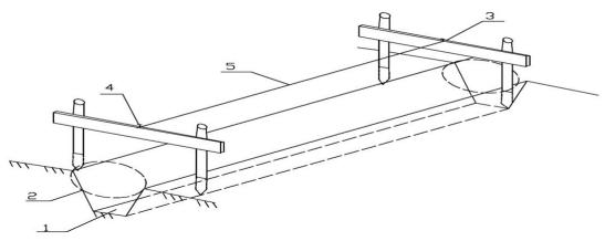
Рис. 15.6. Схема устройства обноски: 1 — траншея; 2 — проектное положение колодца; 3 — доска; 4 — гвоздь; 5 — проволока (причалка)
