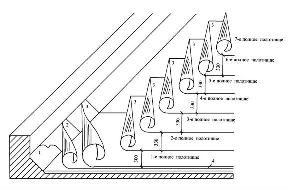
**Рис. 11.2.** Одновременная наклейка трехслойного рулонного ковра: 1 – полотнище шириной 330 мм; 2 – то же, шириной 670 мм; 3 – то же, шириной 1000 мм; 4 – начальная кромка
