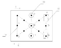
**Рис. 13.5.** Схема провешивания стены отвесом: 1-9 – гвозди; 10 – гипсовые марки; 11 – маячные полосы; 12 – отвес
