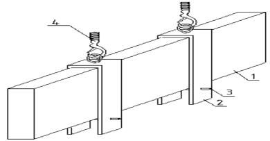
**Рис. 16.25.** Приспособление для демонтажа стеновой панели: 1 – панель; 2 – скоба; 3 – фиксирующий палец; 4 – двухветвевой строп
