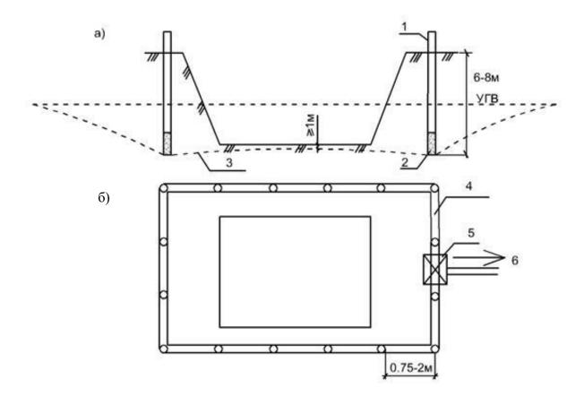
Рис. 3.4. Схема водопонижения с помощью ИФУ:
