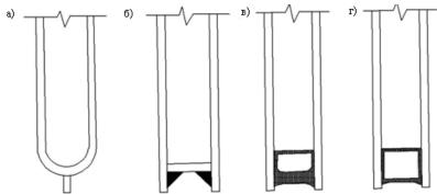
Рис. 12.5. Схема различных видов стеклопакетов:
