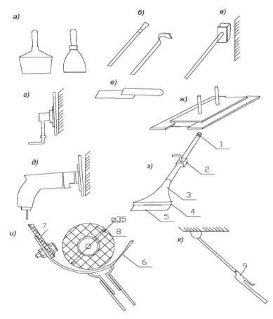
**Рис. 13.9.** Инструменты и аппараты для подготовки поверхностей под покраску: а) – стальные шпатели; б) – скребки; в) – щетка; г) – затирочно-шлифовальная машина пневматическая; д) – то же, электрическая; е) – малярный нож;
