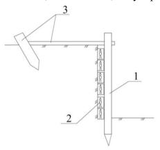
**Рис. 4. 19.** Схема анкерного крепления стенки выемки: 1 - стойка; 2 - доски; 3 - анкер
