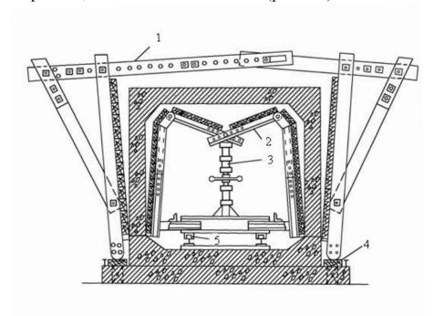
Рис. 8.6. Катучая опалубка для бетонирования проходных каналов:
