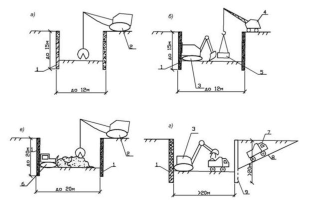
**Рис. 5.9.** Схемы разработки грунта в «ядре»:
