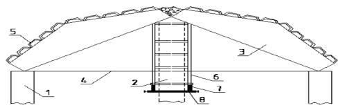
**Рис. 16.20**. Схема увеличения пролета ОПЗ за счет переустройства его из двухпролетного в однопролетное с изменением конструктивной схемы покрытия:
