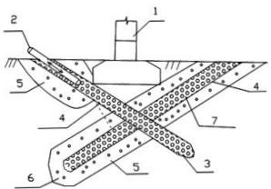
**Рис. 16.5**. Схема усиления основания под существующим фундаментом сваями, устроенные с помощью пневмопробойников:
