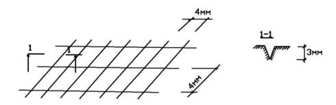
Рис. 13.2. Схема нанесения насечки
