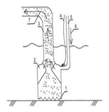
Рис. 3.6. Схема водопонижения с помощью гидроэлеватора: 1 — всасывающий башмак; 2 — эжектор, создающий разряжение; 3 — пульпопровод; 4 — канат для опускания краном гидроэлеватора; 5 — трубопровод для воды; 6 — направление подачи воды; 7 — направление отвода пульпы
