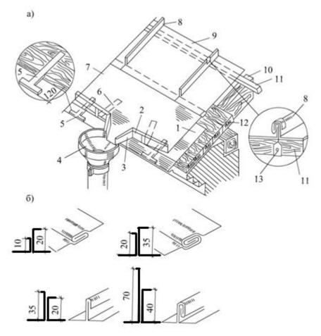
Рис. 11.6. Устройство кровли из стальных листов:
