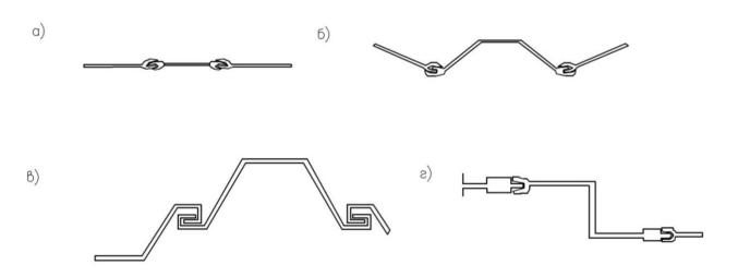
**Рис. 4.23.** Разновидности металлического шпунта: а) – плоский; б) – корытный; в) – корытный типа «Ларсен»; г) – Z-образный
