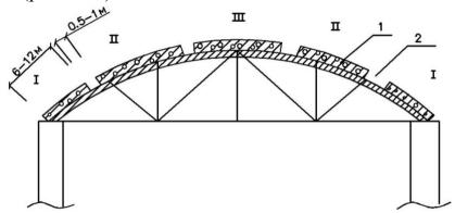
**Рис. 8.17.** Бетонирование сводов и арок пролётом более 15 м: 1 – секция бетонирования; 2 – усадочные промежутки; I-III – последовательность бетонирования
