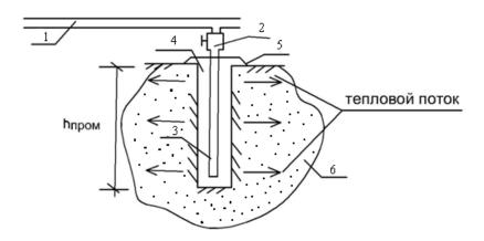
Рис. 4.42. Схема глубинного оттаивания грунта паровыми иглами:
