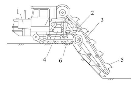
**Рис. 4.15.** Цепной экскаватор продольного копания: 1 — двигатель; 2 — гидроцилиндры подъёма ковшовой рамы; 3 — ковшовая рама; 4 — ленточный транспортер; 5 — ковши; 6 — гусеничное шасси
