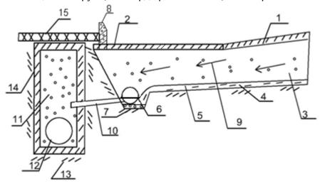
Рис. 3.2. Схема комбинированного дренажа:
