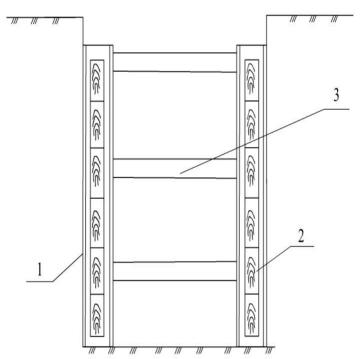
**Рис. 4.17.**Схема распорного крепления стенок траншеи: 1 -стойка из двутавра; 2 -забирка из досок 6 = 5 см; 3 -распорки из брёвен (толщиной 10 - 18 см)
