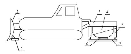
Рис. 4.37. Вибротрамбующая машина:
