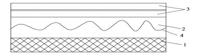
**Рис. 11.4.** Схема устройства полимерной композиции « Поликров»: 1 - поликров AP; 2 - поликров M; 3 - поликров Л (2 слоя); 4 - стеклоткань
