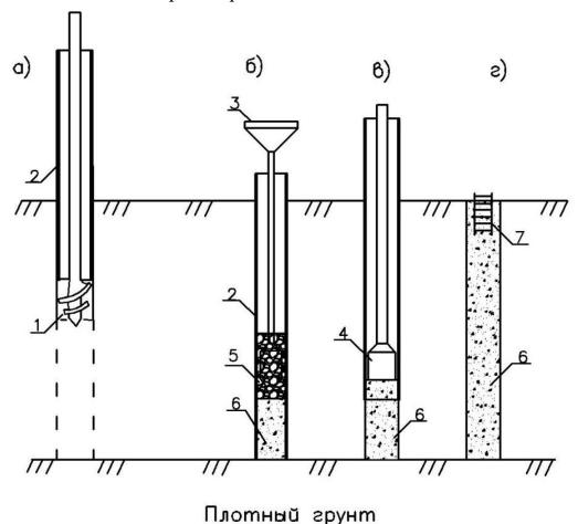
Рис. 6.20. Схема устройства свай Страуса:
