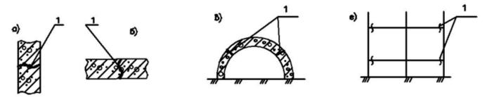
Рис. 8.16. Схемы расположения рабочих швов в железобетонных конструкциях:
