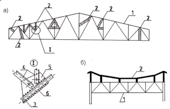
**Рис. 16.8.** Схемы усиления ферм за счет изменения конструктивной схемы: a) – за счет введения дополнительных шпренгелей;
