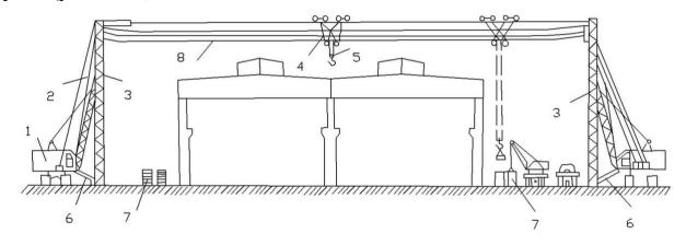
Рис. 16.26. Схема замены покрытия цеха с помощью передвижного кабельного крана:
