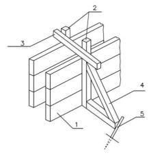
**Рис. 8.1.** Деревянная разборно-переставная опалубка для фундамента: 1 — щит; 2 — стойки; 3 — раскрепляющая планка; 4 — подкос; 5 — клин
