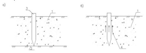
**Рис. 6.3.** Схемы передачи нагрузки сваями на основание: а) — свая-стойка; б) — висячая свая; 1 — слабый грунт; 2 — прочный грунт; 3 — свая; 4 — силы трения
