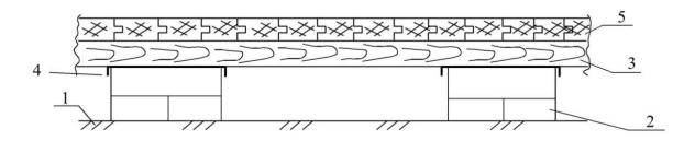
Рис. 14.6. Схема устройства дощатого пола по грунту:
