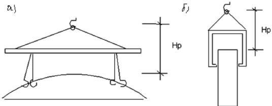
**Рис. 9.15**. Схема определения расчётной высоты приспособлений для монтируемых элементов:
