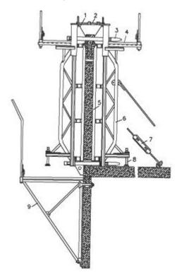
Рис. 8.2. Унифицированная крупнощитовая опалубка:
