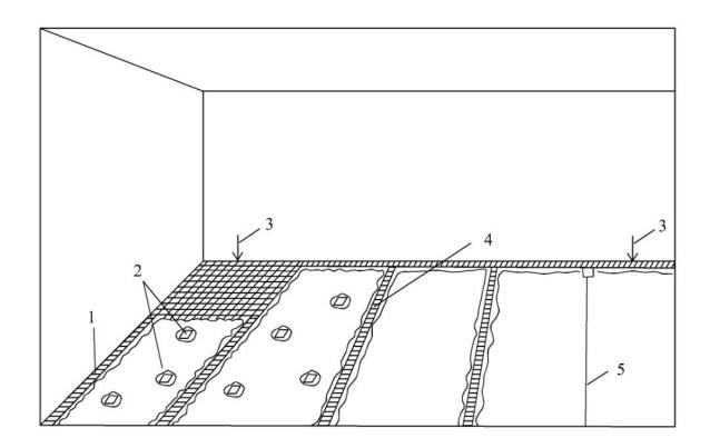
Рис. 14.11. Схема устройства полов из керамических плиток:
