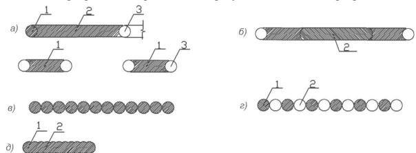
Рис. 5.6. Виды траншейных и свайных стен:
