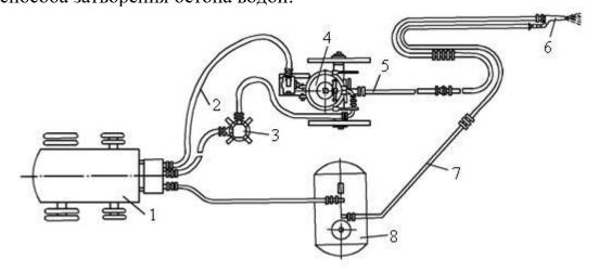
**Рис. 8.18.** Схема мокрого торкретирования: 1 – компрессор; 2 – воздушный шланг; 3 – воздухоочиститель; 4 – цемент-пушка; 5 – материальный шланг; 6 – сопло; 7 – шланг для воды; 8 – ёмкость для воды
