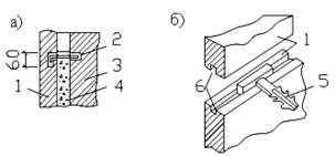
**Рис. 13.15.** Схема крепления плит из природного камня: а) - c помощью крюка б) - c помощью закрепа; 1 - плита; 2 - крюк; 3 - стена; <math>4 - pаствор; 5 - закреп; 6 - паз
