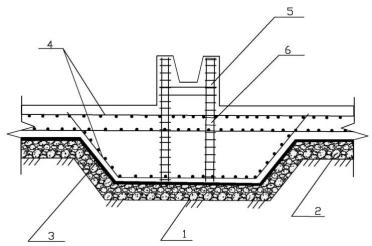
**Рис. 5.3.** Схема устройства монолитной плиты с монолитными стаканами под колонны: 1– уплотненный грунт; 2 – бетонная подготовка; 3 – оклеечная гидроизоляция; 4 – арматура плиты; 5 – монолитный стакан; 6 – арматура стакана
