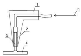
Рис. 4.35. Ручная пневматическая трамбовка:
