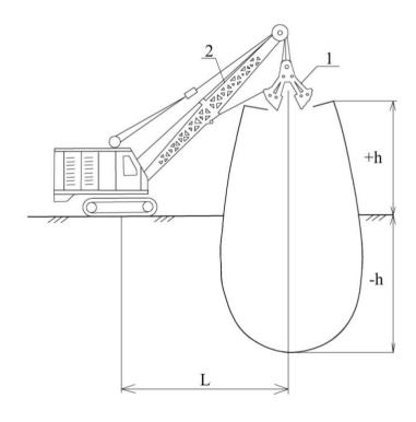
Рис. 4.13. Экскаватор-грейфер: 1 – ковш; 2 – стрела; L – вылет ковша; +h, -h – глубина подъёма ковша и глубина его опускания соответственно
