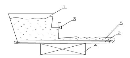
**Рис. 8.12.** Схема универсального дозатора: 1 — бункер; 2 — ленточный питатель; 3 — затвор; 4 — двигатель и система управления; 5 — дозируемый материал
