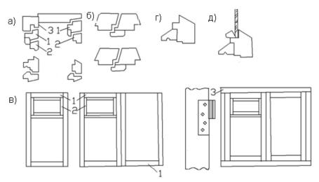
Рис. 12.2. Последовательность сборки оконных блоков с раздельными переплетами: а) – вгонка форточки; б) – подгонка створок с установкой нащельника; в) – установка полупетель; г) – установка отлива; д) – навешивание створок в коробку, установка раскладок по стеклу; 1 – створка; 2 – форточка; 3 – коробка
