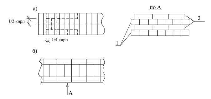
**Рис. 7.6.** Цепная система перевязки швов при толщине стены в 2 кирпича: а) — первый ряд кладки (тычковый); б) — второй ряд кладки (ложковый); 1 — тычковый ряд; 2 — ложковый ряд
