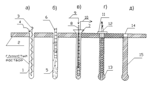
Рис. 16.3. Последовательность работ при устройстве буроинъекционных свай:
