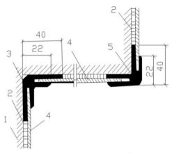
**Рис. 13.13.** Схема закрывания стыков листов бумажно-слоистого пластика с помощью угловых профильных раскладок: 1 — облицовываемая стена; 2 — мастика;
