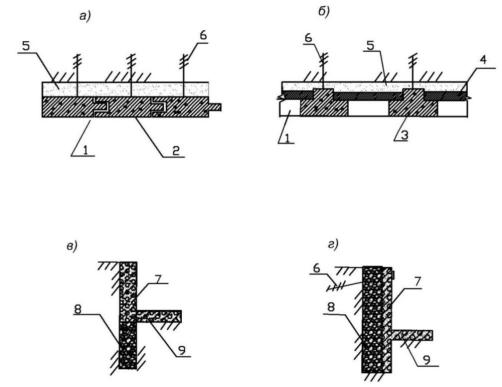
Рис. 5.8. Сборные и сборно-монолитные стены:
