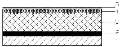
Рис. 10.7. Схема устройства засыпной теплоизоляции: 1 – несущая конструкция; 2 – пароизоляция; 3 – теплоизолирующий слой; 4 – выравнивающая стяжка; 5 – гидроизоляция
