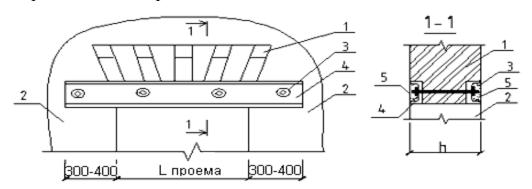
Рис. 16.12. Схема подведения разгружающей балки под усиливаемую перемычку: 1 — усиливаемая перемычка; 2 — кирпичные простенки; 3 — анкерные болты; 4 — швеллеры №16-24; 5 — штукатурка по сетке
