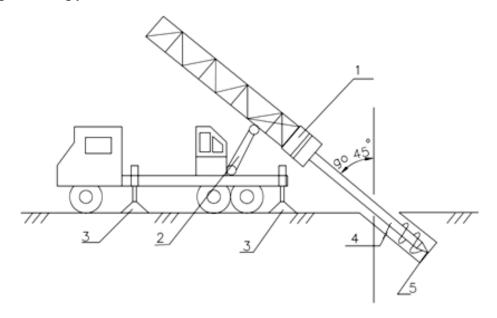
Рис. 6.15. Схема завинчивания сваи:
