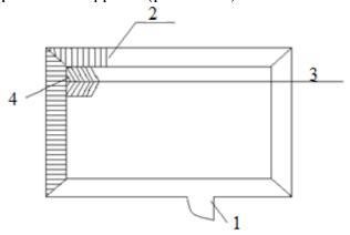
**Рис. 14.9**. Схема укладки паркета с фризом: 1 – вход; 2 – фриз; 3 – шнур; 4 – маячная ёлка
