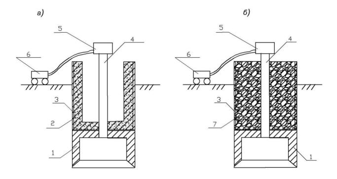
Рис. 5.11. Схема возведения кессонного колодца:
