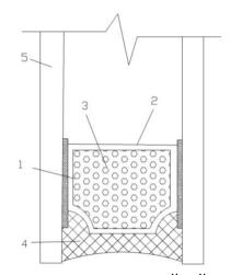
Рис. 12.6. Схема стеклопакета с двойной герметизацией:
