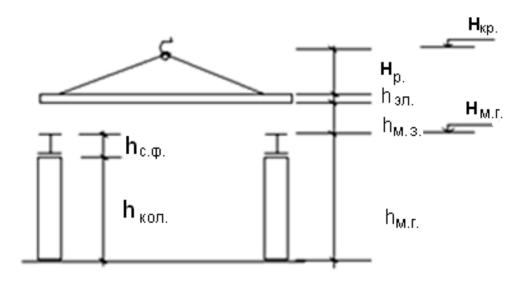
Рис. 9.16. Схема определения требуемой высоты подъёма крюка крана
