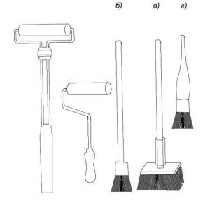
**Рис. 13.10**. Ручной инструмент для малярных работ: a) - валики; б) - маховая кисть; <math>b) - макловица; г) - ручник
