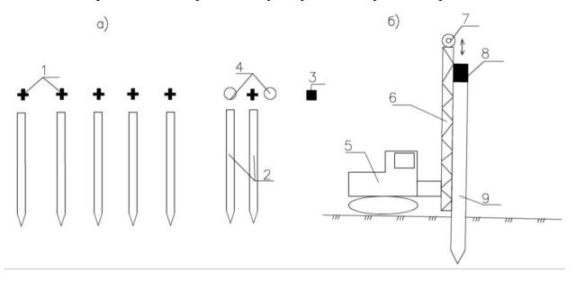
Рис. 6.6. Схема забивки свай:
