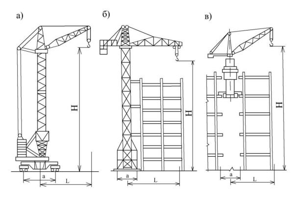
**Рис. 9.6.** Разновидности башенных кранов по способу установки: а) – передвижной; б) – стационарный приставной; в) – самоподъёмный; а – колея крана; L – вылет крюка; H – высота подъёма крюка
