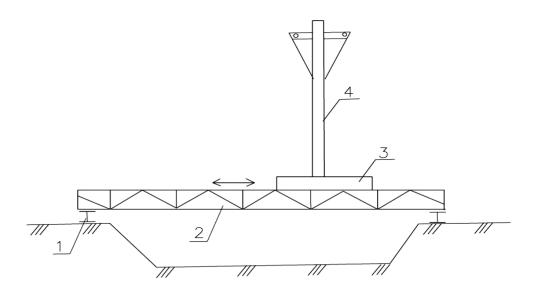
**Рис. 6.13.** Копер мостового типа (КМ): 1 – рельсы; 2 – самоходный мост; 3 – тележка; 4 – копровое оборудование
