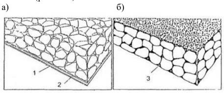
**Рис. 4.28.** Противофильтрационные и водонепроницаемые габионные строительные блоки: а) — с применением мембран; б) — с применением битумной мастики; 1 — геотекстиль; 2 — водонепроницаемая мембрана; 3 — битумная мастика
