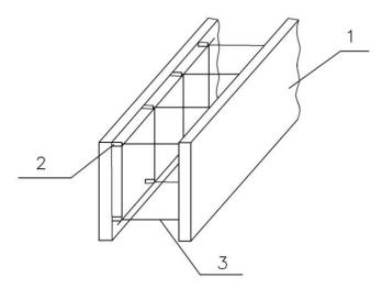
Рис. 8.8. Схема арматурно-опалубочного блока: 1 — опалубочный щит несъёмной опалубки; 2 — выпуски арматуры из опалубочного щита; 3 — арматурный каркас
