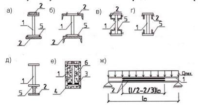
Рис. 16.6. Схемы усиления балок путем увеличения сечений:
