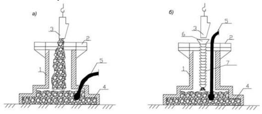
Рис. 5.1. Схема бетонирования монолитных ленточных фундаментов:
