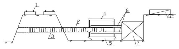
Рис. 15.9. Схема продавливания:
