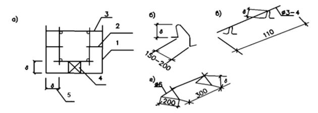
Рис. 8.11. Приемы и приспособления для создания защитного слоя бетона:
