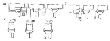
**Рис. 12.1.** Примеры установки дверных блоков в стенах и перегородках: а) – в кирпичных стенах; б) – в стеновых панелях; в) – в перегородках; 1 – вариант со штукатуркой; 2 – наличник; 3 – рейка
