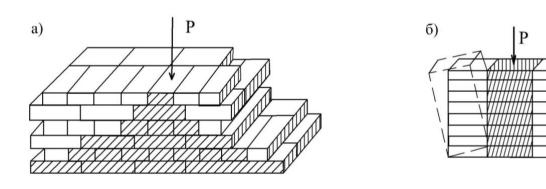
**Рис. 7.5.** Иллюстрации к 3-му правилу разрезки: а) – кладка с перевязкой вертикальных швов; б) – кладка без перевязки швов
