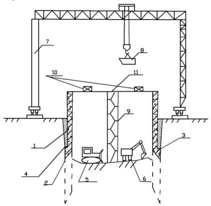
**Рис. 5.10.** Схема устройства опускного колодца: 1 — опускной колодец; 2 — ножевая часть; 3— уступ стены; 4 — глинистый тиксотропный раствор; 5 — бульдозер; 6 — экскаватор; 7 — козловой кран; 8 — бадья; 9 — лестница; 10 — вибропогружатели
