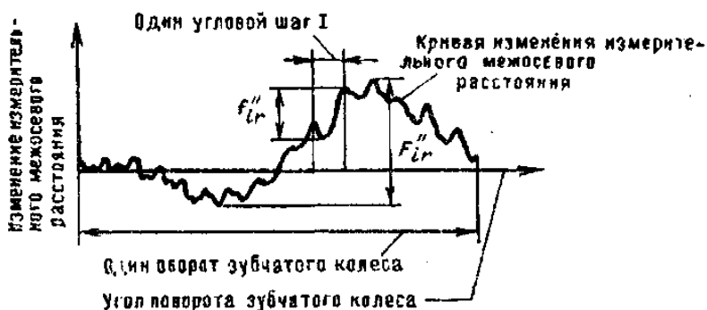
Рис. 5.11. Колебание измерительного межосевого расстояния за оборот
