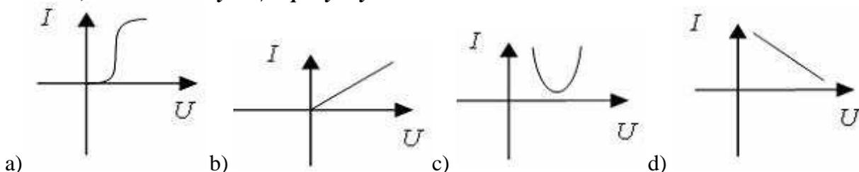
14. Если при токе  $I=5,25A$  напряжение на нелинейном элементе  $U=105B$ , а при возрастании тока на  $\Delta I=0,5A$ , напряжение будет равно  $115B$ , то дифференциальное сопротивление элемента составит...
