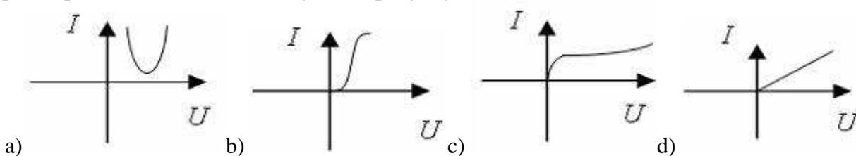
13. Для стабилизации напряжения используется элемент с вольт-амперной характеристикой, соответствующей рисунку...
