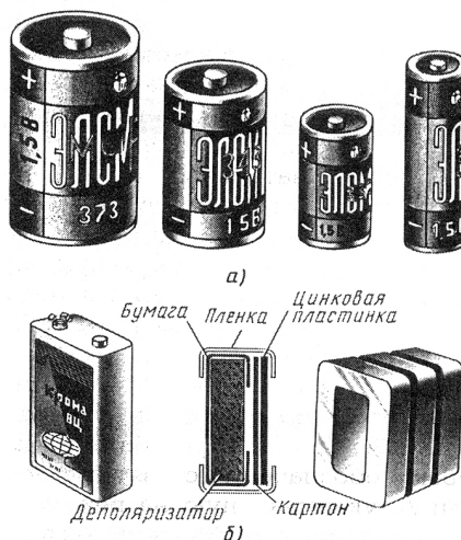
Рис. 36. Гальванические элементы 373, 343, 332 и 316 (а), батарея «Крона ВЦ» и гальванический элемент галетного типа (б) и их УГО
