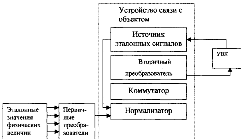
Рисунок 15 - Схема автоматической градуировки измерительных каналов (УВК) управляющий вычислительный комплекс.
