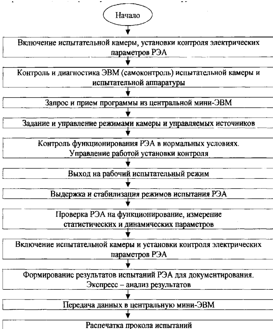
Рисунок 14 - Обобщенный алгоритм управления работой автоматизированной установки испытаний РЭА
