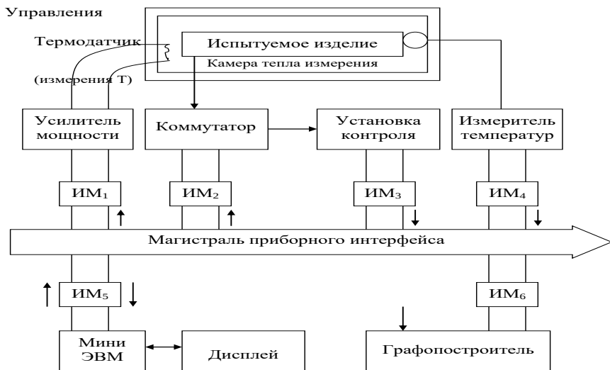
Рисунок 10 - Схема автоматизации проведения испытаний в камере тепла.
