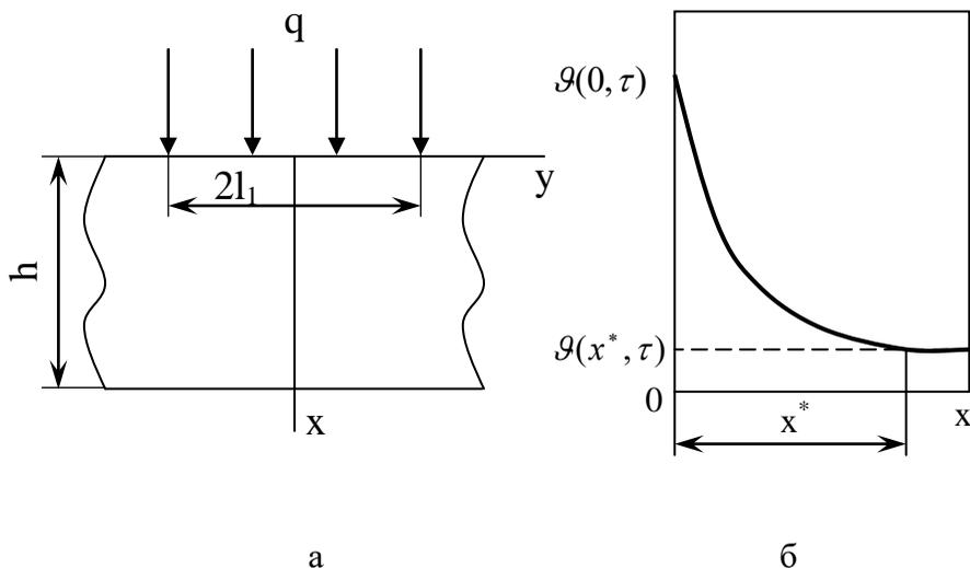
Рис. 1. Импульсный источник энергии: а – на поверхности полупространства; б – характер температурного поля
