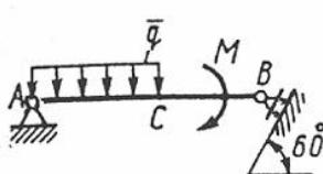
Определить момент  $M$  пары сил, при котором реакция опоры  $B$  равна 250 Н, если интенсивность распределенной нагрузки  $q = 150$  Н/м, размеры  $AC = CB = 2$  м.
