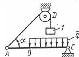
Балка  $AC$  закреплена в шарнире  $C$  и поддерживается в горизонтальном положении веревкой  $AD$ , перекинутой через блок. Определить интенсивность распределенной нагрузки  $q$ , если длины  $BC = 5$  м,  $AC = 8$  м, угол  $\alpha = 45^\circ$ , а вес груза  $I$  равен 20 Н.
