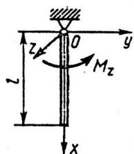
Однородный стержень, масса которого  $m = 8$  кг и длина  $l = 1,5$  м, вращается вокруг оси  $O_z$  под действием пары сил с моментом  $M_z = 12 \cdot \sin(3\pi t/4)$  Н·м. Определить угловое ускорение стержня в момент времени  $t = 2/3$  с.
