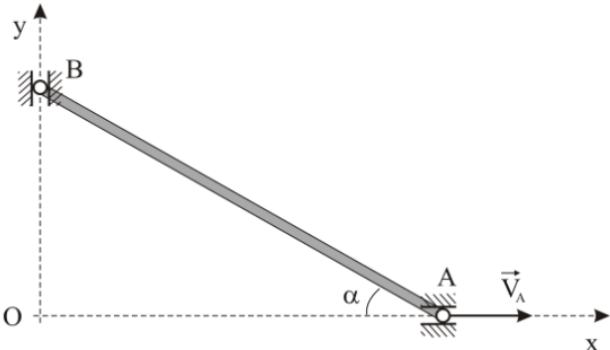
Ползун  $A$  в данный момент времени имеет скорость  $V_A = 4 \text{ м/с}$ ;  $\alpha = 60^\circ$ . Определить скорость ползуна  $B$ .
