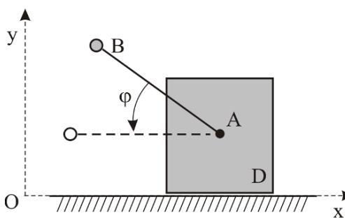
Стержень  $l = 1 \text{ м}$ , несущий на конце шарик  $B$  массой  $m_B = 10 \text{ кг}$  может вращаться вокруг оси  $A$ . Брус  $D$  массой  $m_D = 90 \text{ кг}$  находится на гладкой горизонтальной плоскости. Массой стержня пренебречь. В начальный момент система покоялась. Чему равна проекция перемещения бруса на ось  $Ox$ , если стержень из начального положения  $\varphi = 60^\circ$  перейдёт в горизонтальное.
