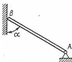
Конец  $B$  однородного бруса весом 100 кН, закрепленного в шарнире  $A$ , опирается на гладкую стену. Определить в кН давление бруса на стену, если угол  $\alpha = 60^\circ$ .
