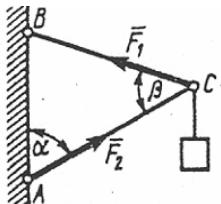
Шарнирный трехзвенник  $ABC$  удерживает в равновесии груз, подвешенный к шарнирному болту  $C$ . Под действием груза стержень  $AC$  сжат силой  $F_2 = 25$  Н. Заданы углы  $\alpha = 60^\circ$  и  $\beta = 45^\circ$ . Считая стержни  $AC$  и  $BC$  невесомыми, определить усилие в стержне  $BC$ .
