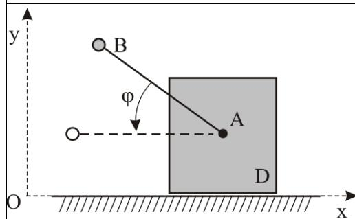
Стержень  $l = 1$  м, несущий на конце шарик  $B$  массой  $m_B = 10$  кг может вращаться вокруг оси  $A$ . Бруск  $D$  массой  $m_D = 90$  кг находится на гладкой горизонтальной плоскости. Массой стержня пренебречь. В начальный момент система покоялась. Чему равна проекция перемещения бруса на ось  $Ox$ , если стержень из начального положения  $\varphi = 60^\circ$  перейдет в горизонтальное.
