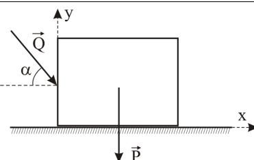
Дано:  $P = 10\text{кН}$ ;  $\alpha = 30^\circ$ ; коэффициент трения  $f = 0.4$ .
