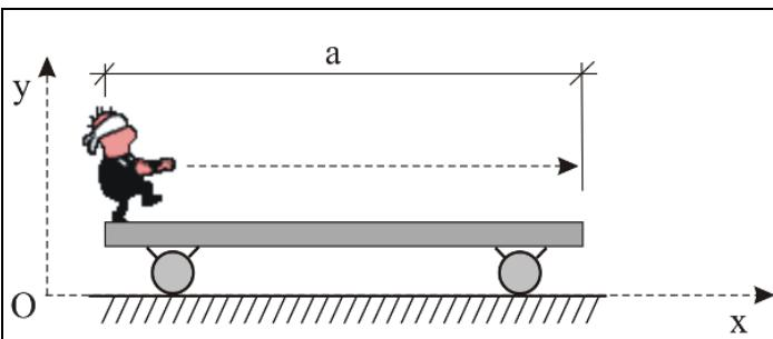
Человек, масса которого  $m_2 = 60$  кг, переходит с одного края платформы на другой. Масса платформы  $m_1 = 240$  кг; длина  $a = 5$  м. В начальный момент времени система покоялась. Сопротивление движению платформы не учитывается. Чему равна проекция перемещения платформы на ось  $Ox$ .
