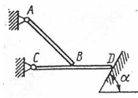
Однородная балка  $AB$ , вес которой  $200 \text{ Н}$ , свободно опирается в точке  $B$  на горизонтальную балку  $CD$ . Определить, с какой силой балка  $CD$  действует на опорную плоскость в точке  $D$ , если расстояние  $CB = BD$ , угол  $\alpha = 60^\circ$ . Весом балки  $CD$  пренебречь.
