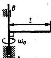
К валу  $AB$  жестко прикреплен горизонтальный однородный стержень длиной  $l = 2$  м и массой  $m = 12$  кг. Валу сообщена угловая скорость  $\omega_0 = 2$  рад/с. Предоставленный самому себе, он остановился, сделав 20 оборотов. Определить момент трения в подшипниках, считая его постоянным.
