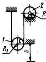
массой  $m_1 = m_2$  и радиусами  $r_1 = r_2$ , однородные диски, начинают движение из действием силы тяжести. Определить скорость того, как он опустился вниз на расстояние  $s = 3$  м.
