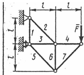
Определить усилие в стержне  $3$ . Сила  $F = 460 \text{ Н}$ .
