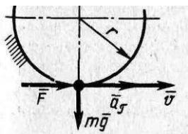
Материальная точка массой  $m = 0,1$  кг скользит по негладкой, вертикально расположенной направляющей радиуса  $r = 0,4$  м. В самом нижнем положении скорость точки  $v = 4$  м/с, а касательное ускорение  $a_t = 7$  м/с<sup>2</sup>. Определить мгновенное значение силы  $F$ , если коэффициент трения  $f = 0,1$ .
