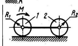
Однородные цилиндрические катки  $1$  и  $2$  массой 20 кг каждый приводятся в движение из состояния покоя постоянным вращающим моментом пары сил  $M = 2$  Н·м. Определить скорость осей катков при их перемещении на расстояние 3 м, если радиусы  $r_2 = r_1 = 0,2$  м.
