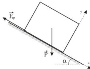
Каким должен быть наибольший вес груза 2, для того, чтобы груз 1 весом 100 Н оставался в покое на наклонной плоскости, если коэффициент трения скольжения  $f = 0.3$ .
