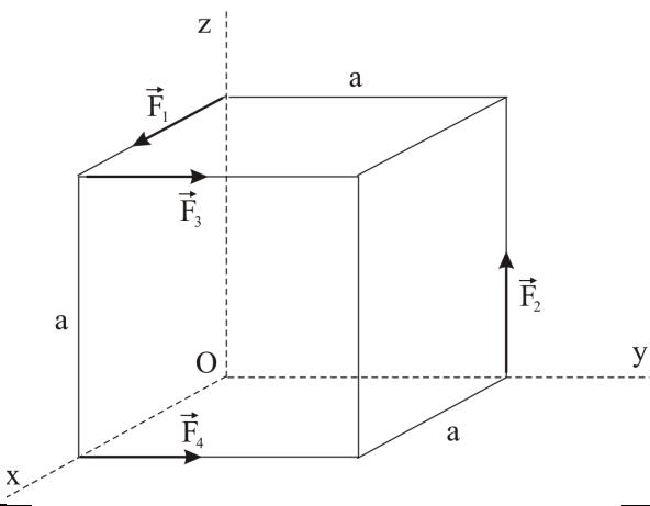
К кубу с ребром  $a$  приложена система двух одинаковых по модулю сил  $|\vec{F}_1| = |\vec{F}_2| = P$ .
