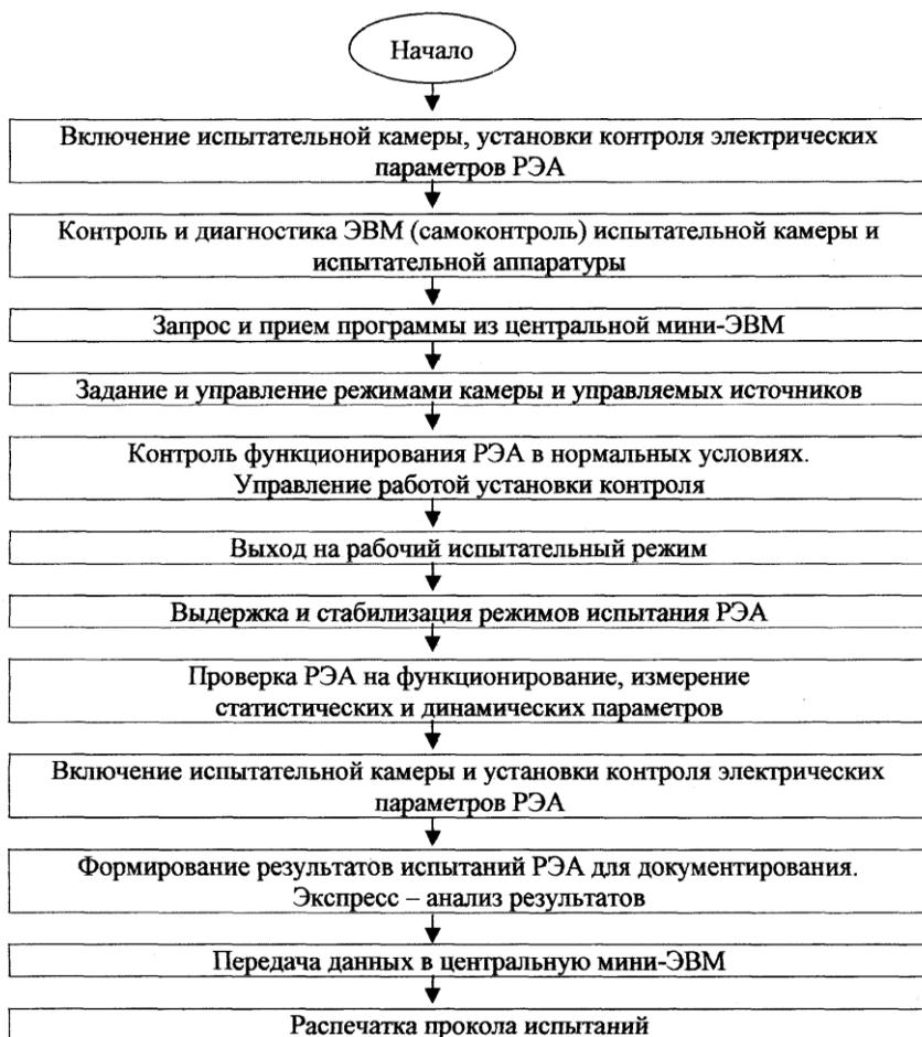
Рис. 6.14. Обобщенный алгоритм управления работой АУИ радиоаппаратуры
