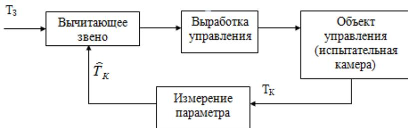
Рис. 6.1. САУ:  $T_k$  – параметр камеры;  $T_3$  – заданные значения параметра камеры;  $\hat{T}_k$  – оценка параметра канала
