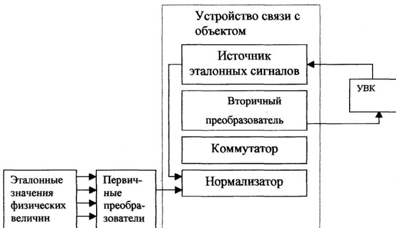
Рис. 6.15. Схема АГИТ — управляющий вычислительный комплекс (УВК)
