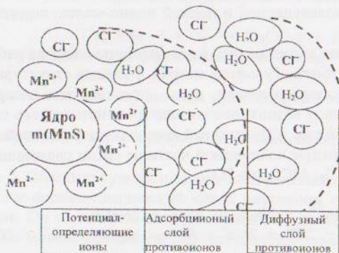
Рис. 1. Схема строения гидрозоля сульфида марганца, полученная в избытке \text{MnCl}_2
