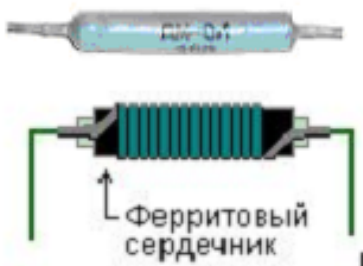
Рисунок 1 - Внешний вид и устройство катушки индуктивности
