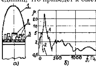
Рисунок 3.3 — Виброзащита электронных элементов а — носовая часть ракеты; 1 — корпус ракеты; 2 — электронные элементы; 3 — плата; б — частотная характеристика платы; 1 — однородная плата; 2 — плата с антирезонансными слоями
