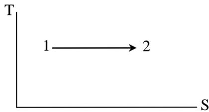
а)  $p_1 = p_2 \frac{v_2}{v_1}$ ;
