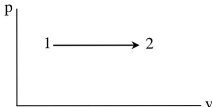
а)  $q = \Delta u + p(v_2 - v_1)$ ;
