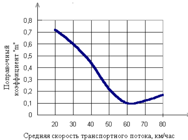
Рис. 4.1. Зависимость коэффициента m , учитывающего дорожные и автотранспортные условия движения от скорости транспортного потока
