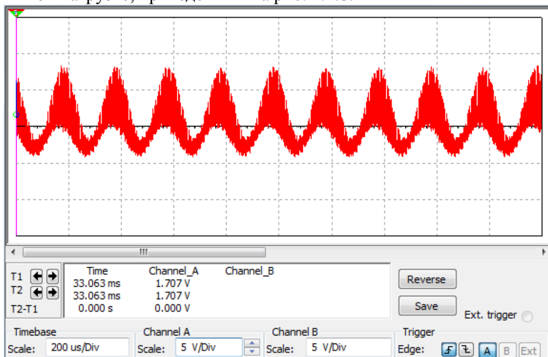
Рис. 1.4.8. Бигармонический сигнал с отсечкой при резистивной нагрузке с коллекторной модуляцией
