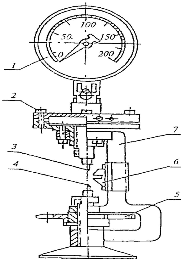
1 - манометр; 2 - гидравлическая мессдоза; 3 - верхний зуб; 4 - нижний зуб;
